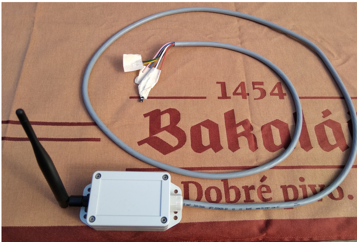
Obr. 14 Zapouzdřený hardware, ven z krabičky zasahuje pouze anténa Sigfoxu a kabel se senzory, ty jsou kvůli ochraně obaleny
