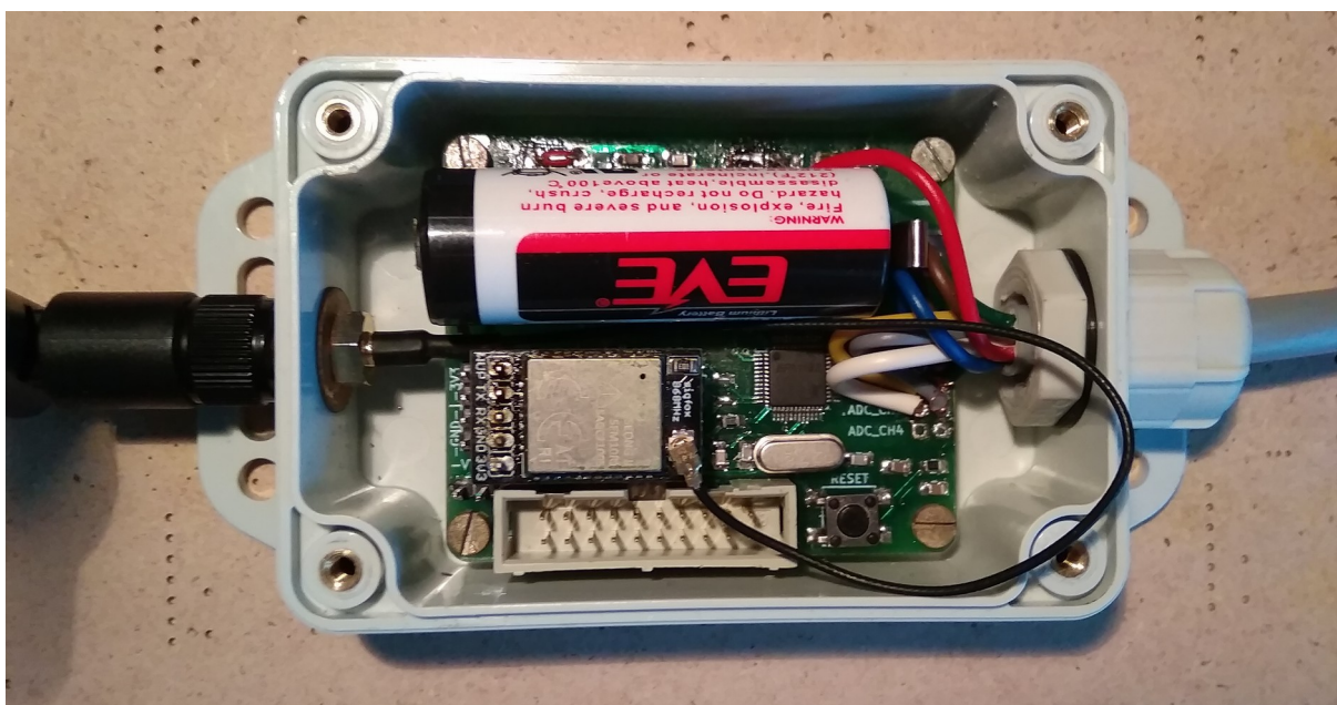
Obr. 13 Osazená deska v krabičce s připojenou baterií, senzory (vpravo), Sigfox modulem a anténou (vlevo)
