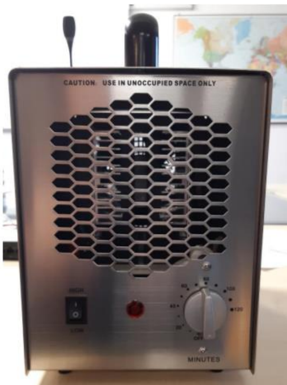
Obrázek 3 Generátor ozónu používaný při testování účinnosti dekontaminace, zdroj: TÚPO
