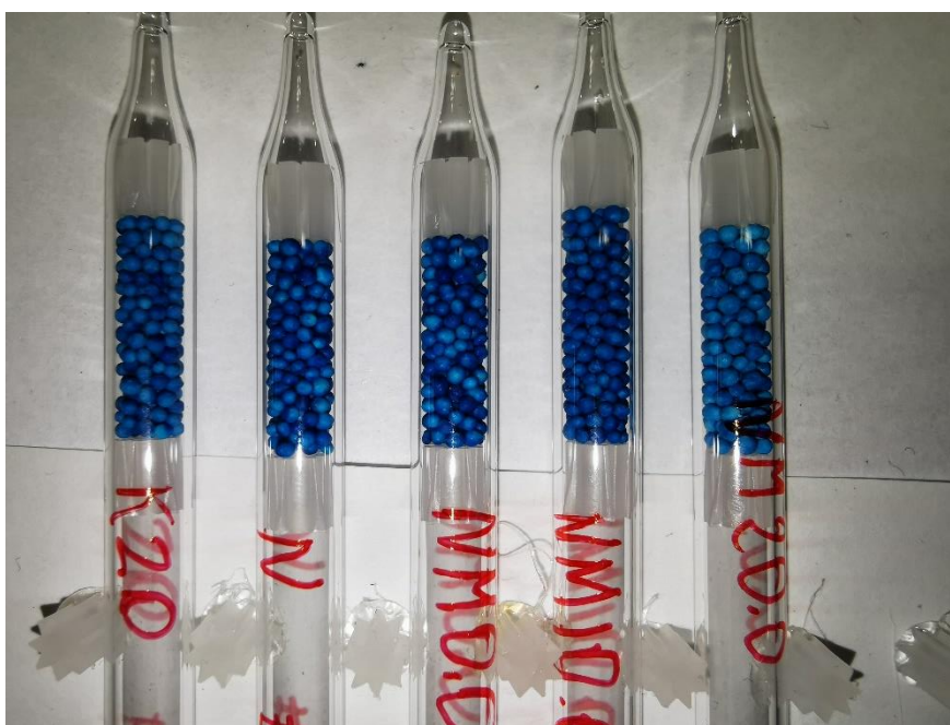
Obrázek 14 - - Vzorky pelet impregnovány Ethanolem. Foto ve skleněných trubičkách po vysušení
