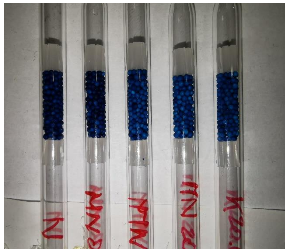
Obrázek 16 - Vzorky pelet s acetonem ve skleněných trubičkách Zdroj: vlastní
