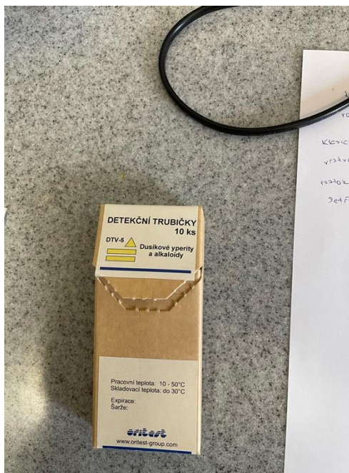
Obrázek č. 1 vlevo - Snímek detekční trubičky DTV-5 pro analýzu vody a roztoků, zdroj: vlastní
