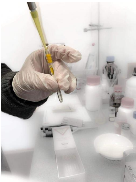
Obrázek č. 5 vlevo - Pomocí nasávače (pipety) dopravený roztok do trubičky, zdroj: vlastní Obrázek č. 6 vpravo ruční nasávací zařízení UNIVERSAL - provedení 10 zdvihů, zdroj: vlastní
