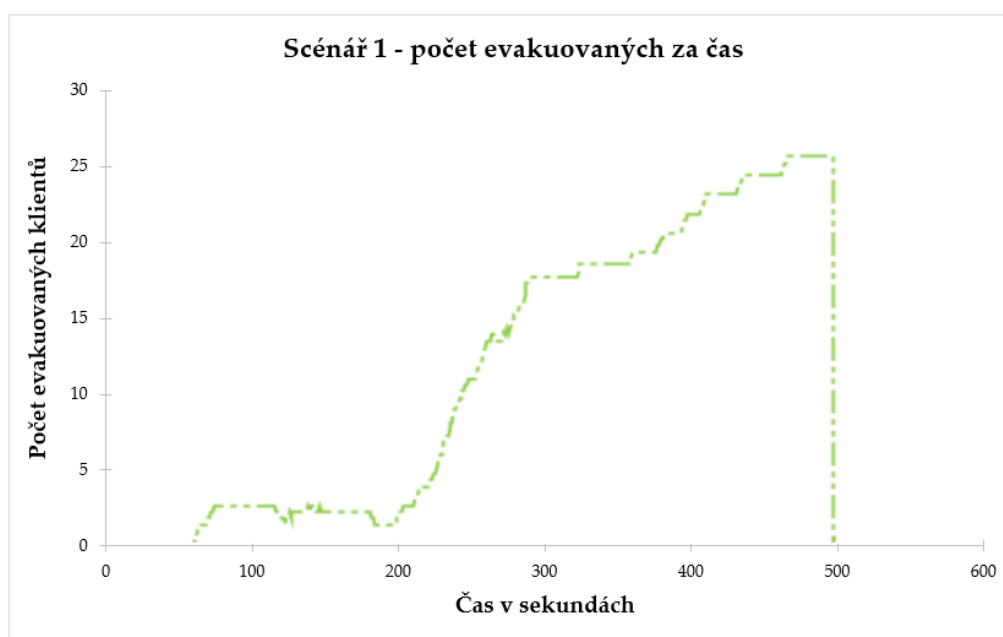
Obrázek 20 – Scénář 1 - graf zobrazující nárůst evakuovaných na shromaždiště za určitý čas (kolísání grafu způsobuje personál, který se na shromaždiště opakovaně vracel) [Pathfinder, vlastní úprava]
