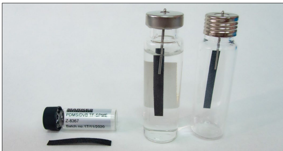
Obrázek 21 – Použití PDMS/DVB pásku pro techniku TF-SPME
