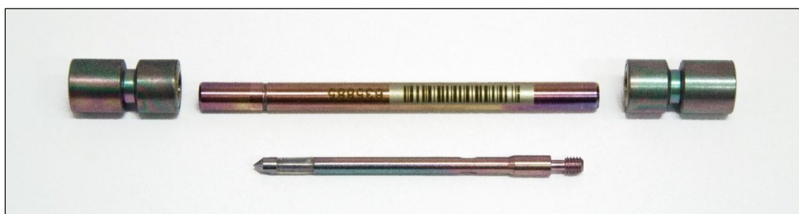
Obrázek 20 – Možnost použití HiSorb™ sondy v TD trubičce
