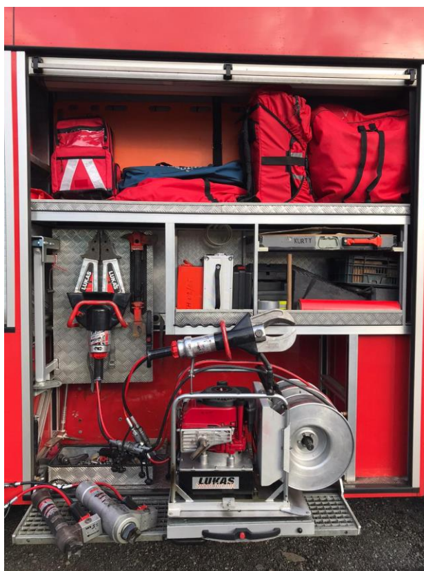
Obrázek 6 – Praktické uložení VPPO a sady HVZ [9]
