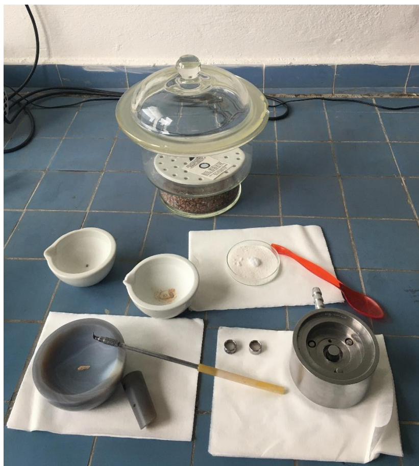
Obrázek 14 – Pomůcky potřebné na výrobu vzorkové tablety (dole zleva: achátová třecí miska s tloučkem, špachtle, vzorkové kroužky, tabletovací forma, uprostřed zleva: třecí misky, Petriho miska s KBr, plastová lžička, nahoře: exikátor se silikagelem (zdroj vlastní)
