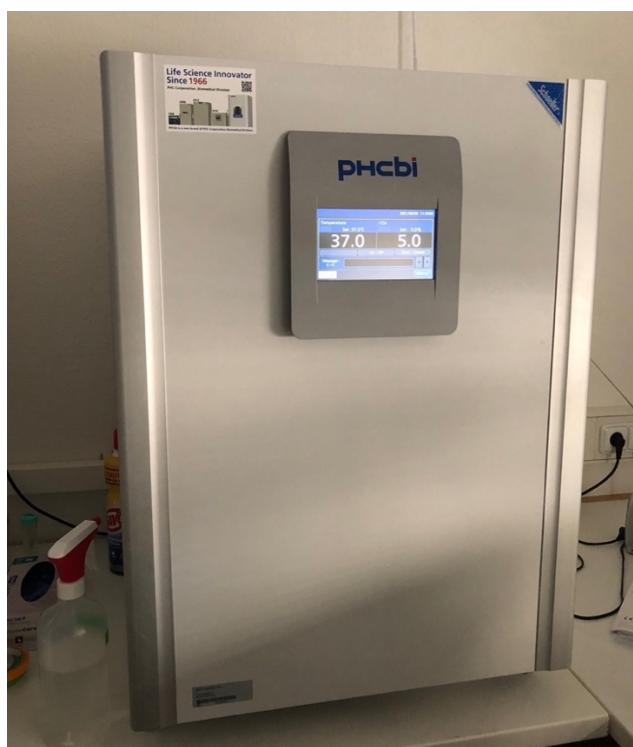
Obrázek 11 – Inkubační box MCO-170AIC používaný pro kultivaci (vlastní zdroj).
