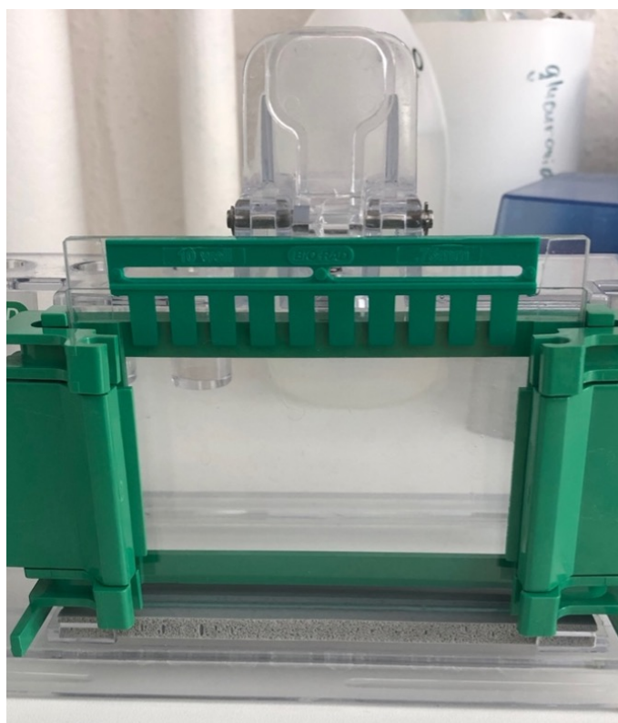
Obrázek 15 – Příprava polyakrylamidového gelu (vlastní zdroj).
