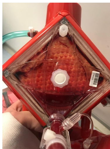
Obrázek 7 Koagula usazená v membránovém oxygenátoru (zdroj: archiv autora)
