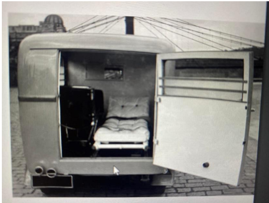
Obrázek 9 - Pohled do Sanitního vozu Škoda 430 z pražské karosárny Šebek a Vyskočil (Tuček, 2019)
