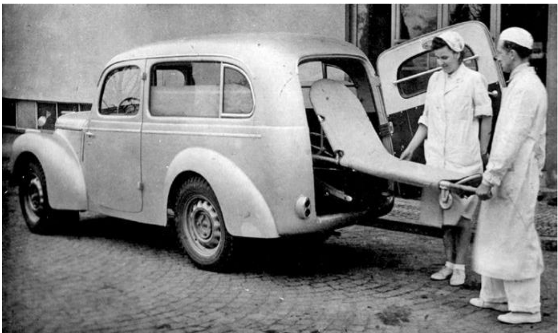
Obrázek 19 - Přístup do sanitního prostoru sanitky 1101 byl pouze zadními dveřmi (Tuček, 2019)
