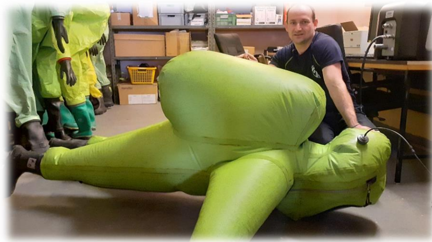
Obrázek 11 – Tlaková zkouška protichemického obleku Vautex
