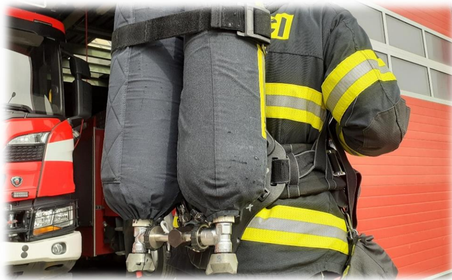
Obrázek 19 – Z praktického výzkumu autora diplomové práce vzešel závěr, že tzv. dvoumontáž není vhodná na běžné zásahy v DP, ale své uplatnění může nalézt při použití v ochranném protichemickém obleku
