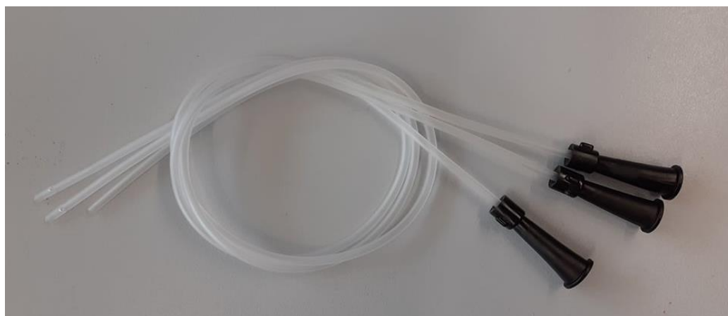
Obrázek 4.8: Použité katetry sloužící k zavedení optické sondy pro měření teploty
