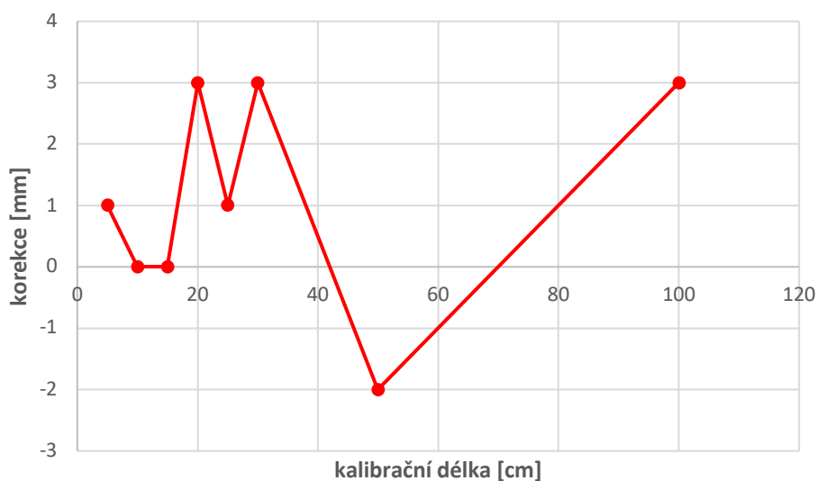
Graf 4.2: Korekční křivka ultrazvukového senzoru HC-SR04
