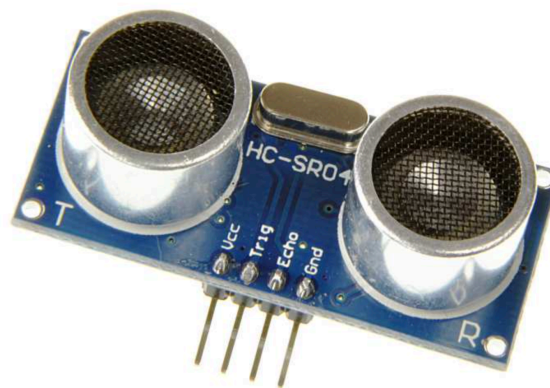
Obrázek 4.7: Ultrazvukový měřič vzdálenosti HC-SR04 [24]
