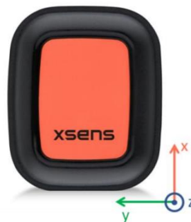
Obrázek č. 4.7: Souřadnicový systém senzoru Xsens DOT [49]
