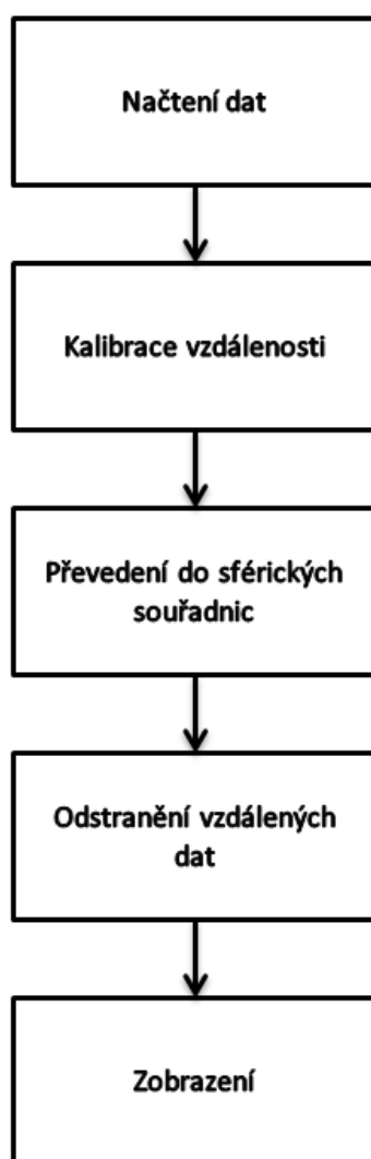
Obrázek 4.7: Blokové schéma úpravy dat v programovém prostředí Matlab
