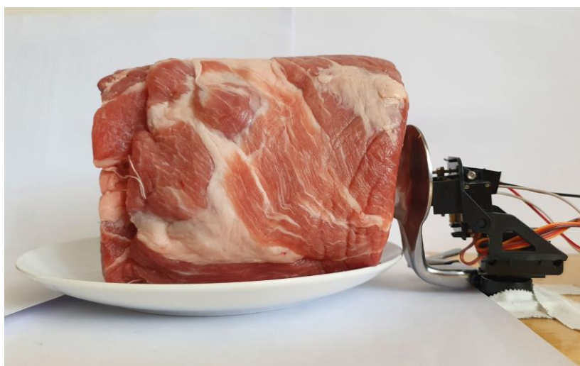
Obrázek 4.21: Skenování masového fantomu senzorem ToF
