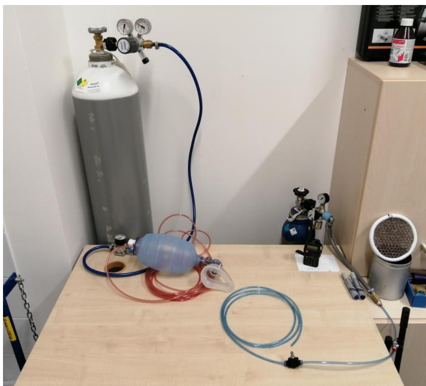
Obr. č. 4.6: Lahev s kyslíkem a dýchací maskou, lahev a hadička s N_2O
