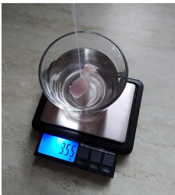
Obr. 4.5: Měření objemu vzorku na váze [zdroj: autor]
