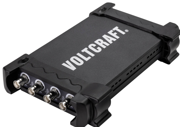
Obrázek 4.10: VOLT CRAFT DSO-3204 USB osciloskop 200 MHz 4kanálový 250 MSa/s 16 kpts 8 Bit s pamětí (DSO) [30].
