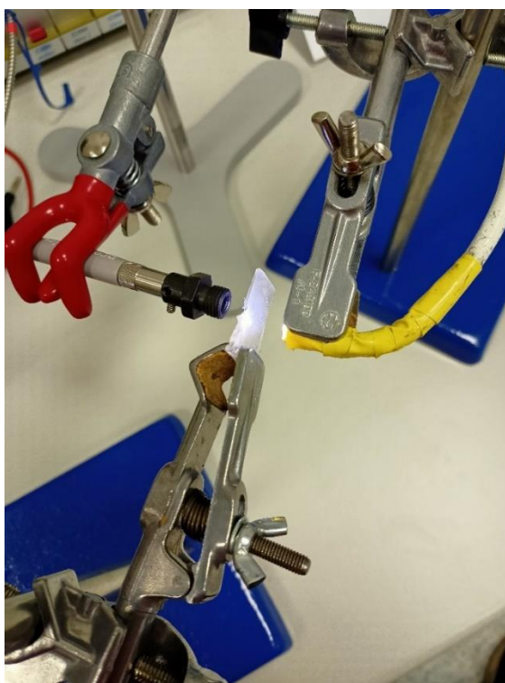
Obr. 5.2: Uspořádání prvků aparatury pro měření vlnového spektra bronchoskopu
