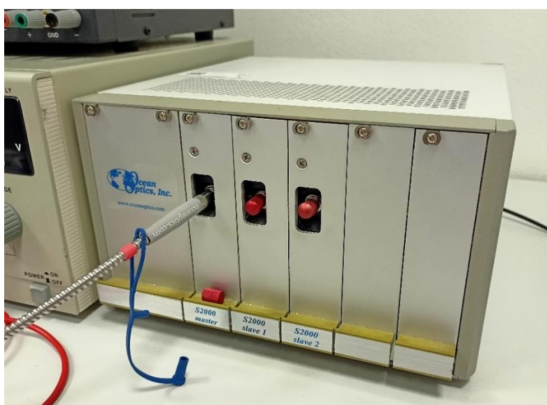
Obr. 4.1: Spektrofotometr S2000 společnosti Ocean Optics
