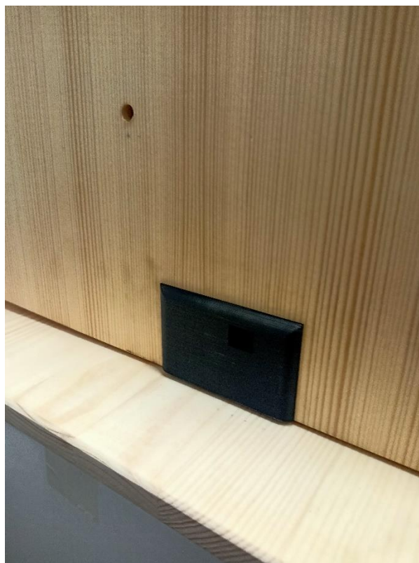
Obr. 5.33: Deska s USB portem a otvor pro vstup bronchoskopu do simulátoru
