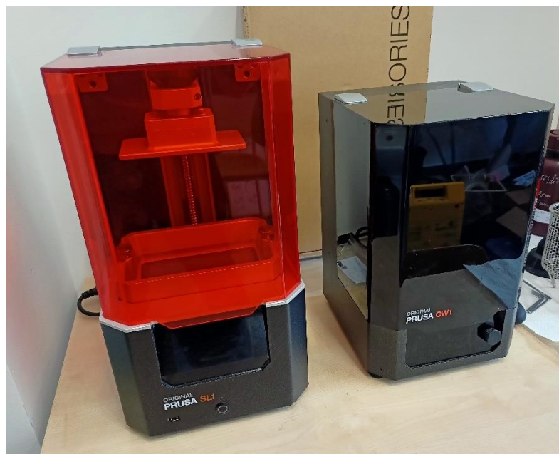
Obr. 4.5: Tiskárna SL1 (vlevo) s promývací a vytvrzovací stanicí CW1 (vpravo)
