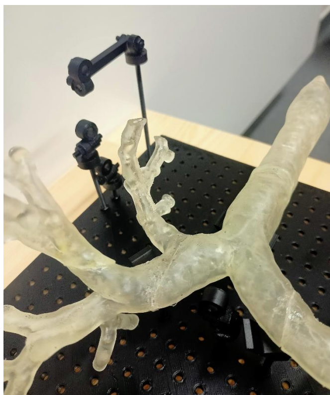
Obr. 5.39: Znázornění umístění držáků fototranzistorů s usazeným modelem bronchiálního stromu
