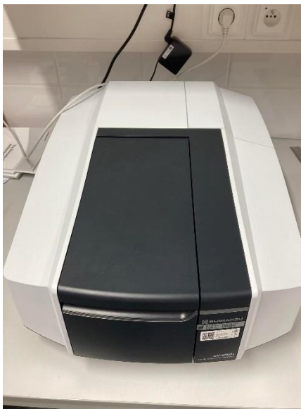
Obrázek 15: UV-VIS spektrofotometr Shimadzu UV-2600 (vlastní zdroj)
