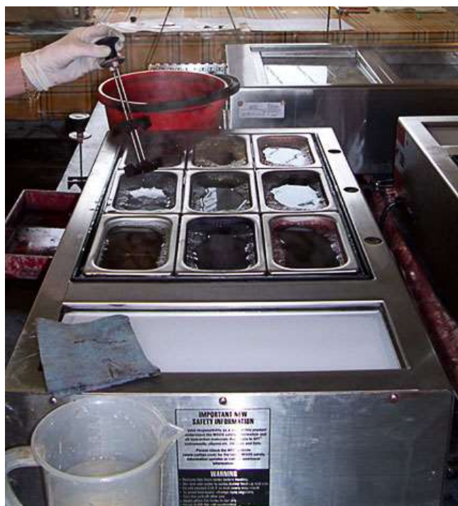
Obrázek 13: Hromadné barvení brýlových čoček. [21]
