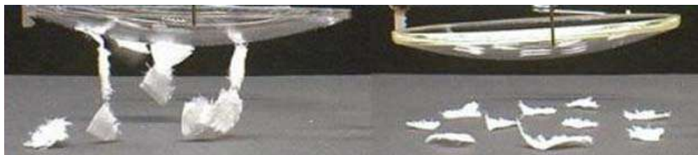
Obrázek 16: Antistatická vrstva u čočky vpravo. [21]
