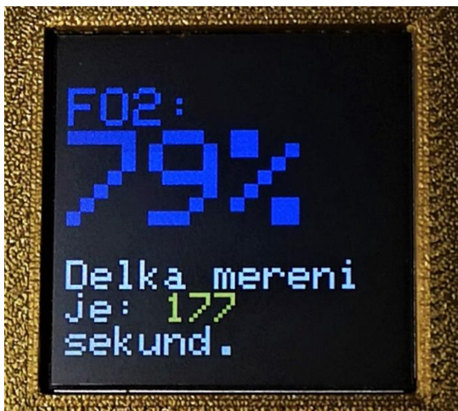
Obrázek 5.6: Obrazovka pro zobrazení koncentrace kyslíku.
