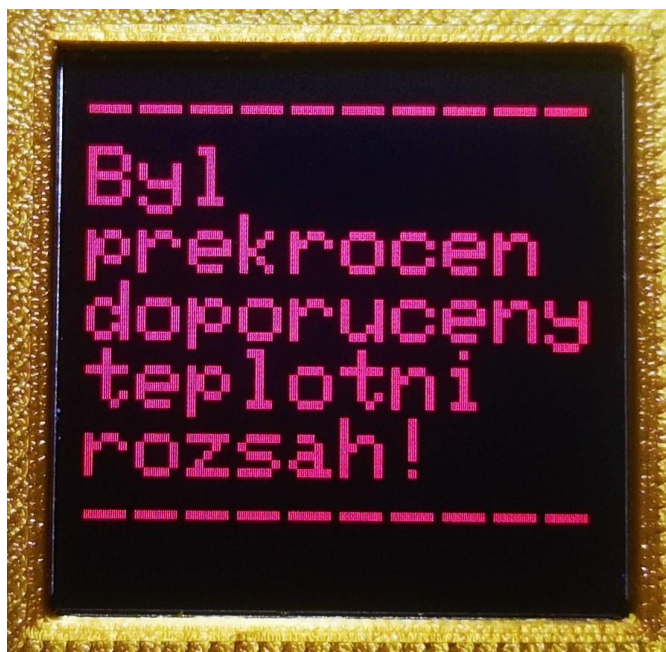
Obrázek 5.7: Obrazovka, která se zobrazí pouze při překročení doporučeného teplotního rozsahu.
