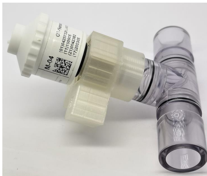
Obrázek 5.9: Redukční port se senzorem (na levé části obrázku) a zástrčkou (na pravé části obrázku).
