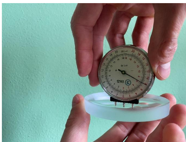
Obrázek 18: Měření zadní křivky sférometrem
