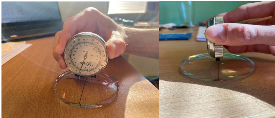
Obrázek 17: Sférometr-měření přední křivky a ukázka polohy sférometru z boku
