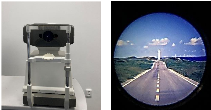
Obrázek 14: Autorefaktometr GR-21 a použitý testovací obrázek [vlastní zpracování]
