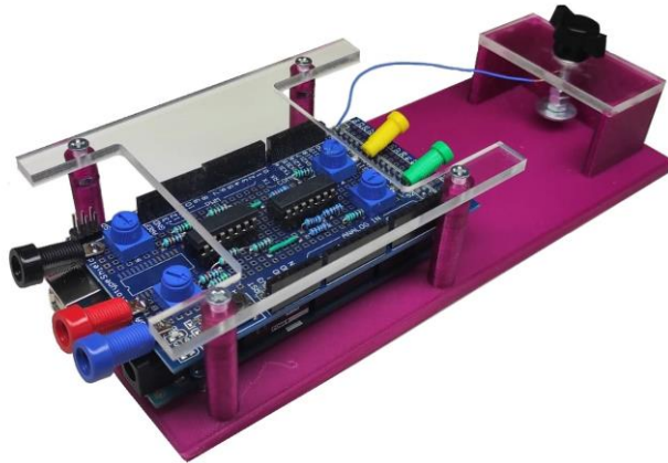
Obrázek 5.3: Kompletní platforma simulátoru intrakardiálních signálů s deskou Arduino Mega 2560 a modulem Prototypem Shield.
