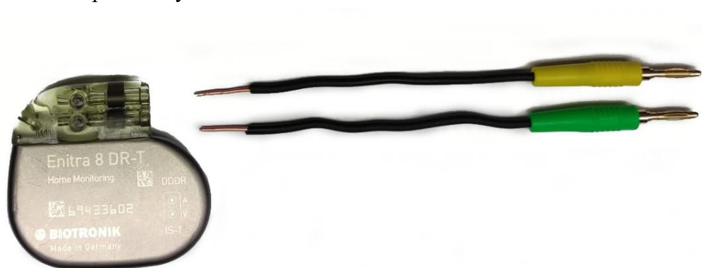
Obrázek 4.14: Kardiostimulátor BIOTRON Enitra 8 DR-T s propojovacími kabely pro vodivé spojení kardiostimulátoru a simulátoru intrakardiálních signálů.
