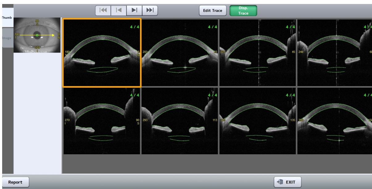
Obrázek 12: Casia2 – přední segment oka v osmi řezech s detekovanou nitrooční čočkou
