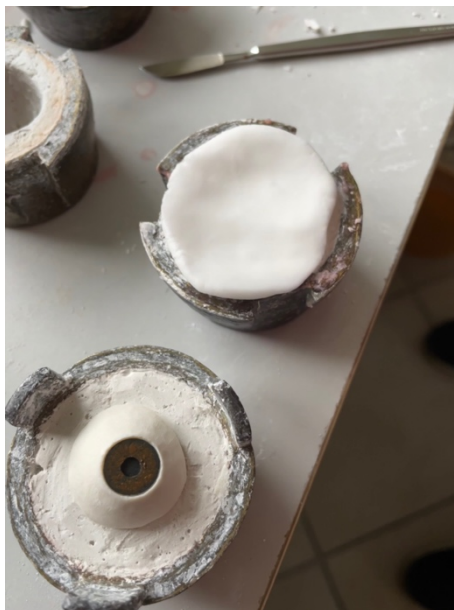
Obrázok 17: Ukážka kyvety pred druhou polymerizáciou
