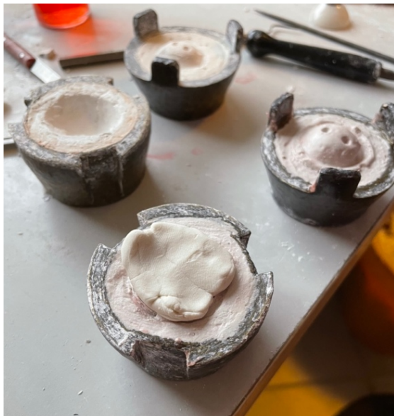
Obrázok 12: Kyveta naplnená Superpontom C+B
