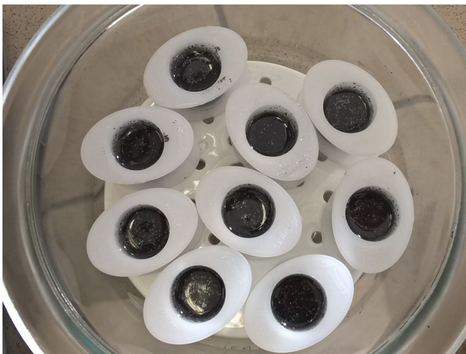
Obr. 16. Vzorky v pryskyřici s uhlíkovými částicemi [archiv autorky]
