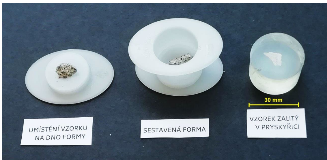
Obr. 15. Zalévání vzorku do epoxidové pryskyřice [archiv autorky]
