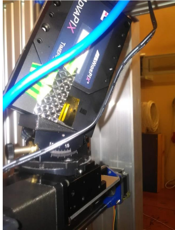
Obr. 20 Vzorek „diamantové“ reflexní folie byl nalepen přes okénko detektoru. Na fotografii je vidět detail usazení detektoru na otočném držáku, který je zrovna natočen o 30°.
