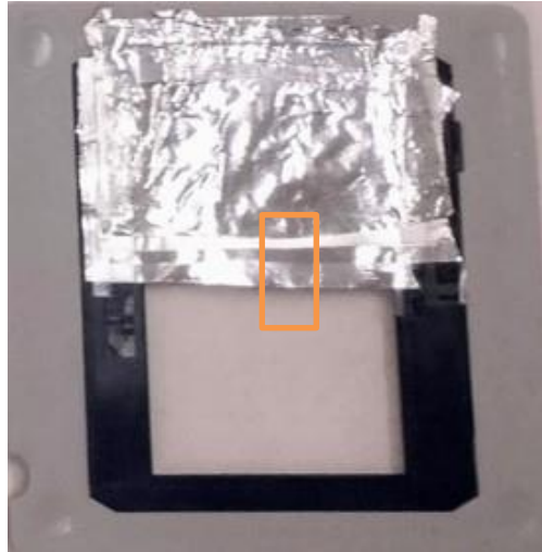
Obr. 44 Příklad složeného vzorku ( D ). Zde jsou zobrazeny schodovitě poskládané hliníkové folie o celkových tloušťkách 0, 5, 10, 25 a 30 mm. Oranžový obdélník označuje oblast, která byla proskenována svazkem [49].
