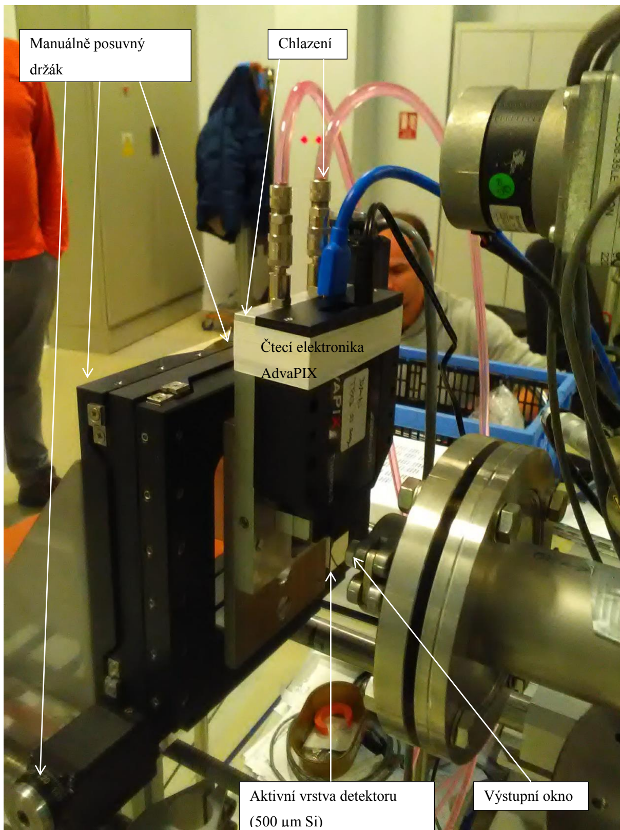
Obr. 42 Umístění detektoru na pohyblivý držák: K pohyblivému držáku byl detektor AdvaPIX-TPX3 připevněn pomocí hliníkové chlazené desky. S držákem bylo možné pohybovat pomocí jemného posuvu v osách X a Y . Manuální ovládání posuvu ve směru osy Y se nachází v levém dolním rohu fotografie
