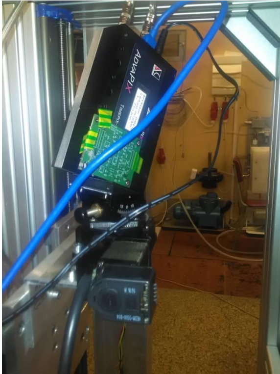
Obr. 19 Vzorek neosazeného plošného spoje byl nalepen přímo na kryt detektoru přes okénko nad senzorem. Na fotografii je vidět detail celého těla detektoru přimontovaného na otočném držáku
