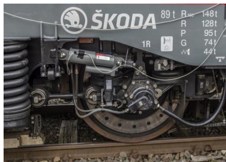
Obr. 5 Magnetoreologický tlumič a jeho zástavba do pojezdu lokomotivy ř. 109 E
