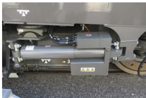
Obr. 4 Elektrohydraulický aktuátor Liebherr a jeho zástavba do podvozku lokomotivy Vectron
