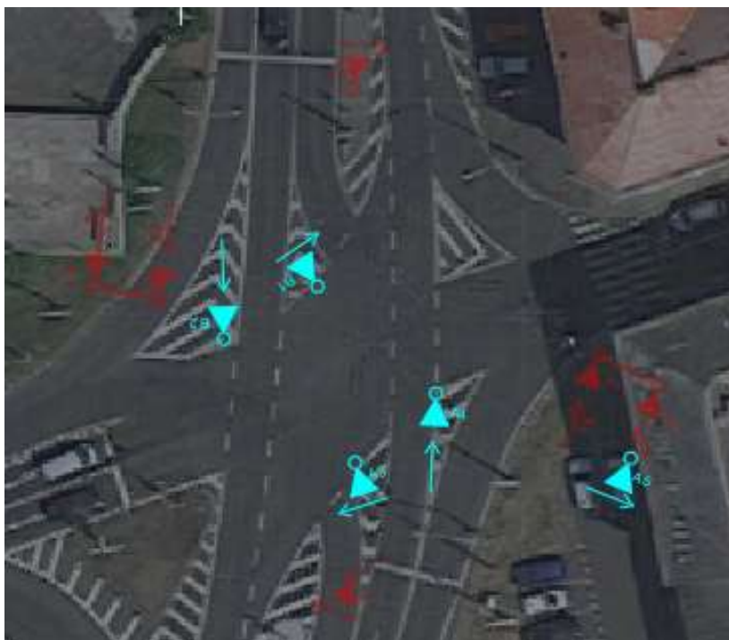
Obrázek 27 – Snímek z výkresu řešení č.1, úpravy SSZ (zdroj: Příloha 2.2 – Variantní řešení křižovatky č.1 této práce, vlastní tvorba)
