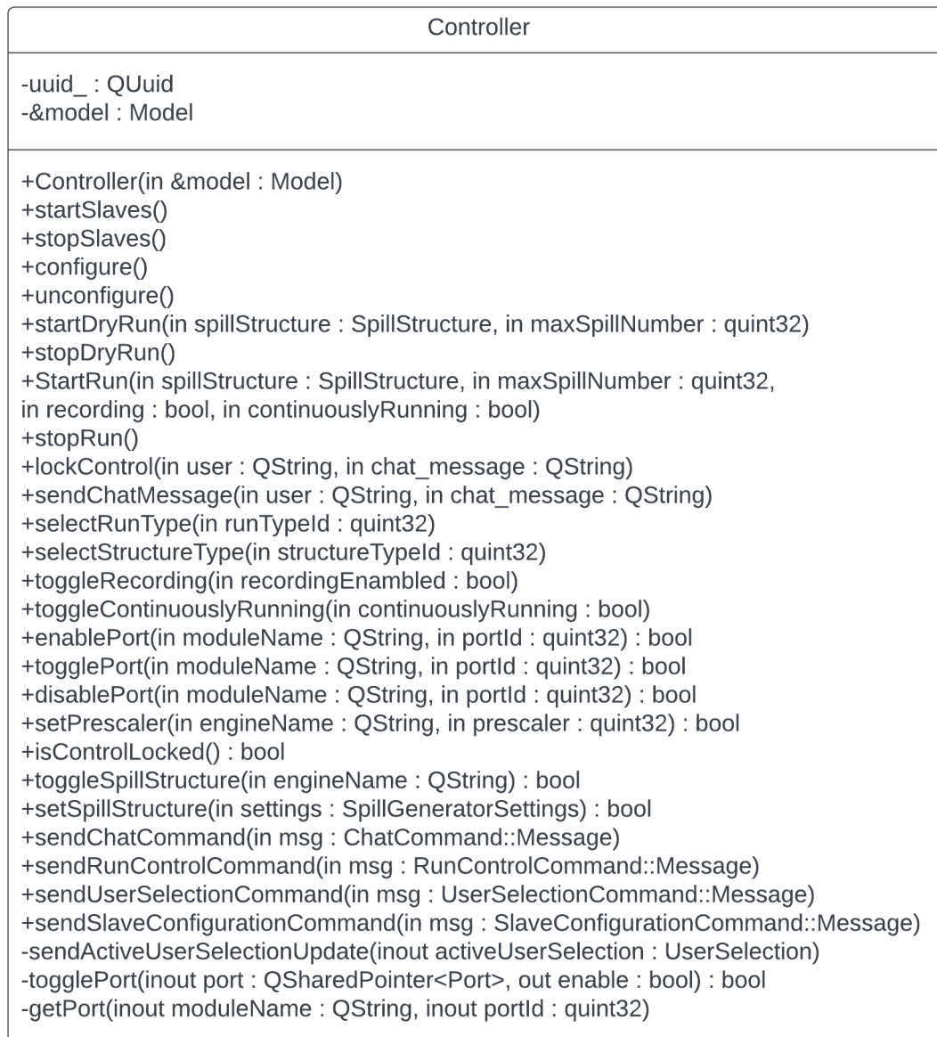
Obrázek 4.1: Blok UML diagramu třídy Controller z CCC [23]
