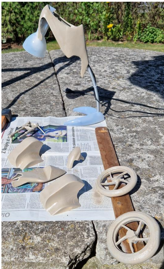
Obrázek 27: Schnutí všech částí motocyklu po aplikování plniče
