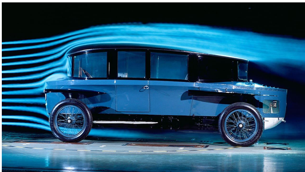
Obrázek 3: Tropfenwagen v aerodynamickém tunelu s vizualizací okolního proudění [3]
