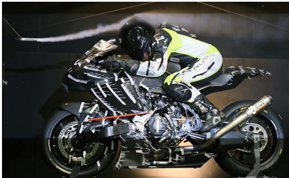
Obrázek 21: Zobrazení kouřové a „bavlnkové“ metody [33]
