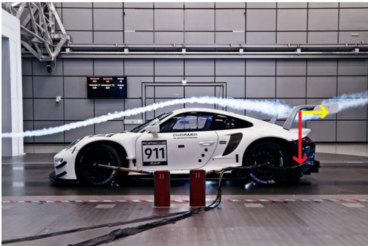
Obrázek 15: Zobrazení přítlačné síly vyvinuté spoilerem [17]
