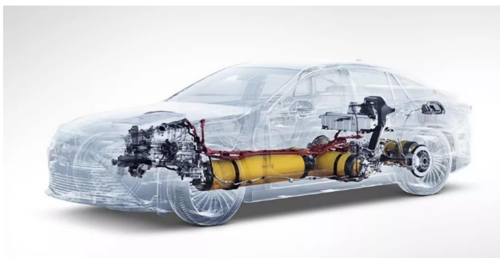
Obrázek 3 Vodíkové ústrojí Toyoty Mirai
