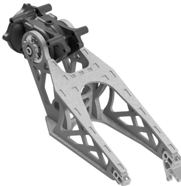
Obrázek 29: Kompletní převodová skříň se zadní kyvnou vidlicí motocyklu CTU Lions EVO 2.0
