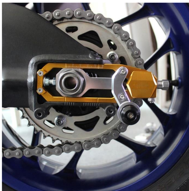
Obrázek 6: Napínák řetězu na motocyklu Suzuki GSXR1000 [8]
