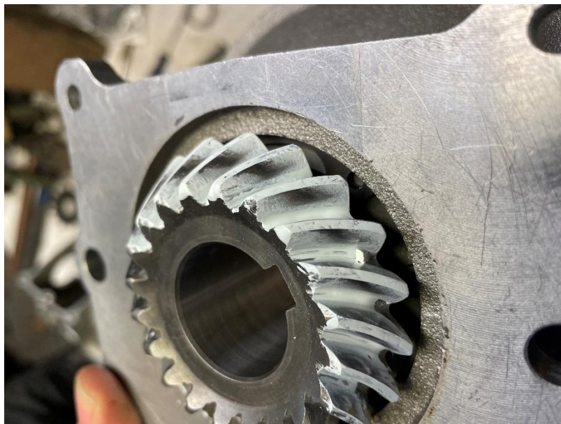
Obrázek 33: Otisk zubů na pastorku soukolí na motocyklu CTU Lions EVO 2.0
