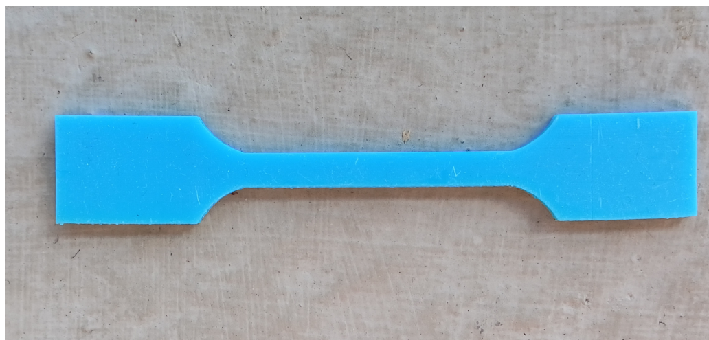
Obrázek 7.2: Vytisknutý zkušební vzorek na tahovou zkoušku
