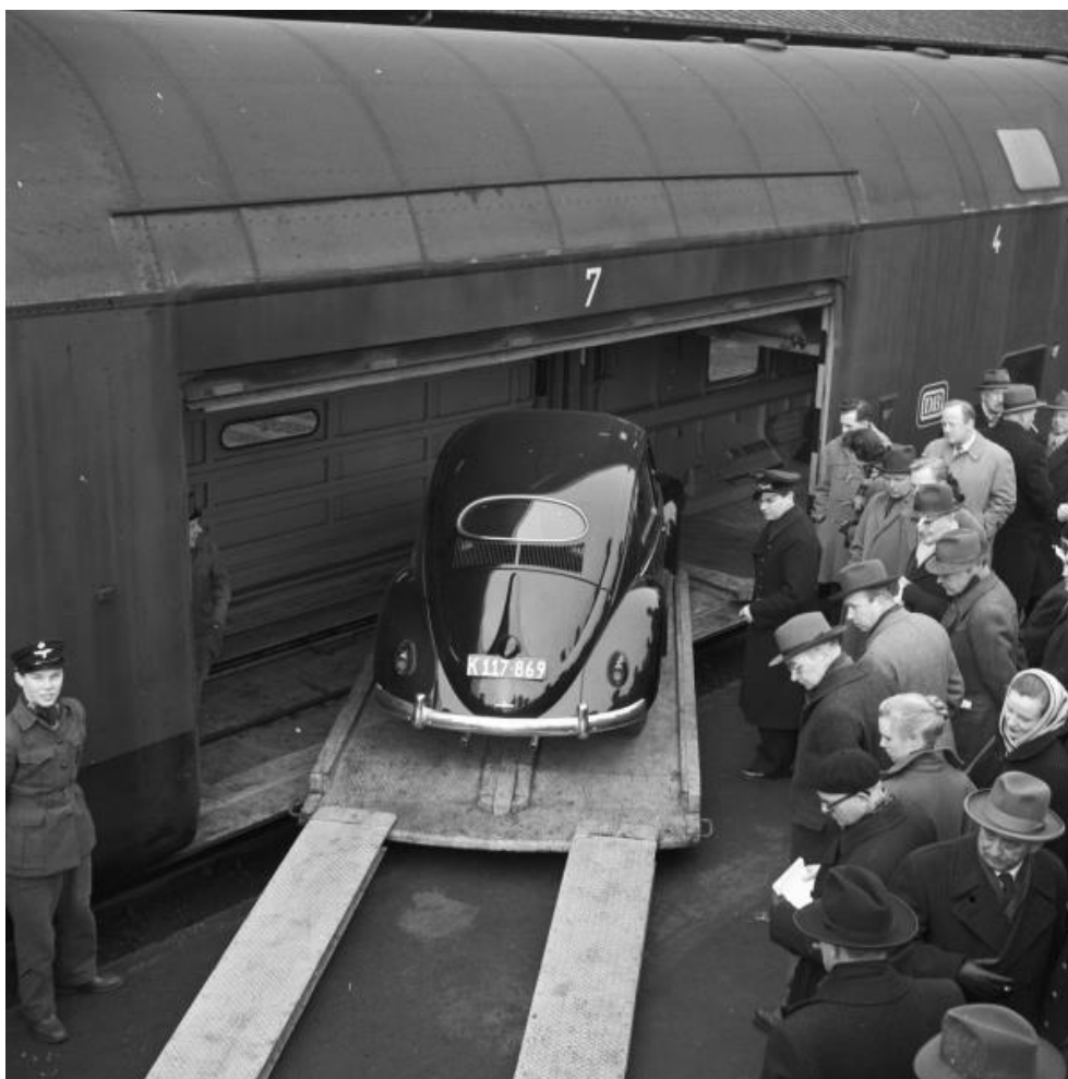
Obrázek 38: Nakládání vozidel do vozu DPw4ümg [38]
