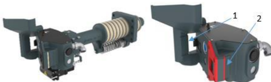
Obrázek 94: Spřáhlo Schwab (vlevo včetně vypružení, vpravo hlava) [108]
