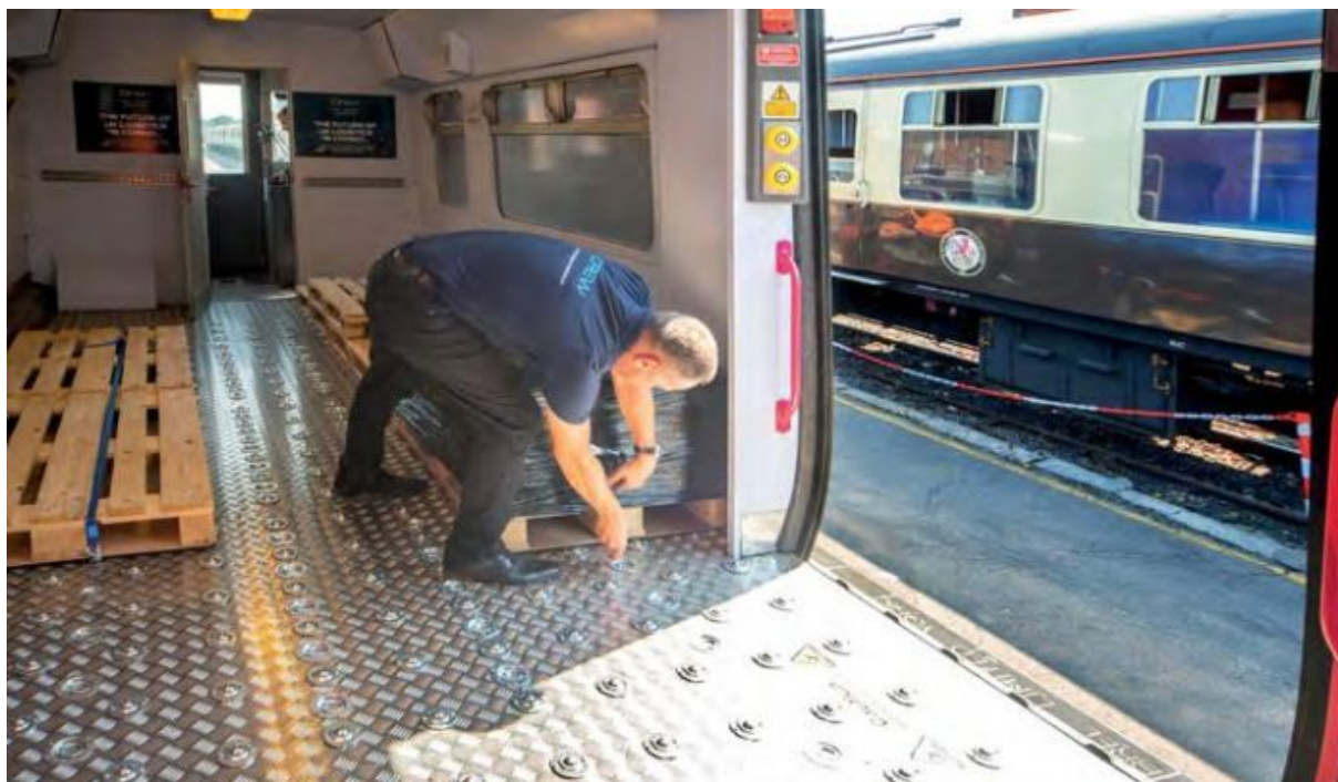
Obrázek 22: Nákladový prostor s kuličkovými rolnami jednotky řady 319 [18]
