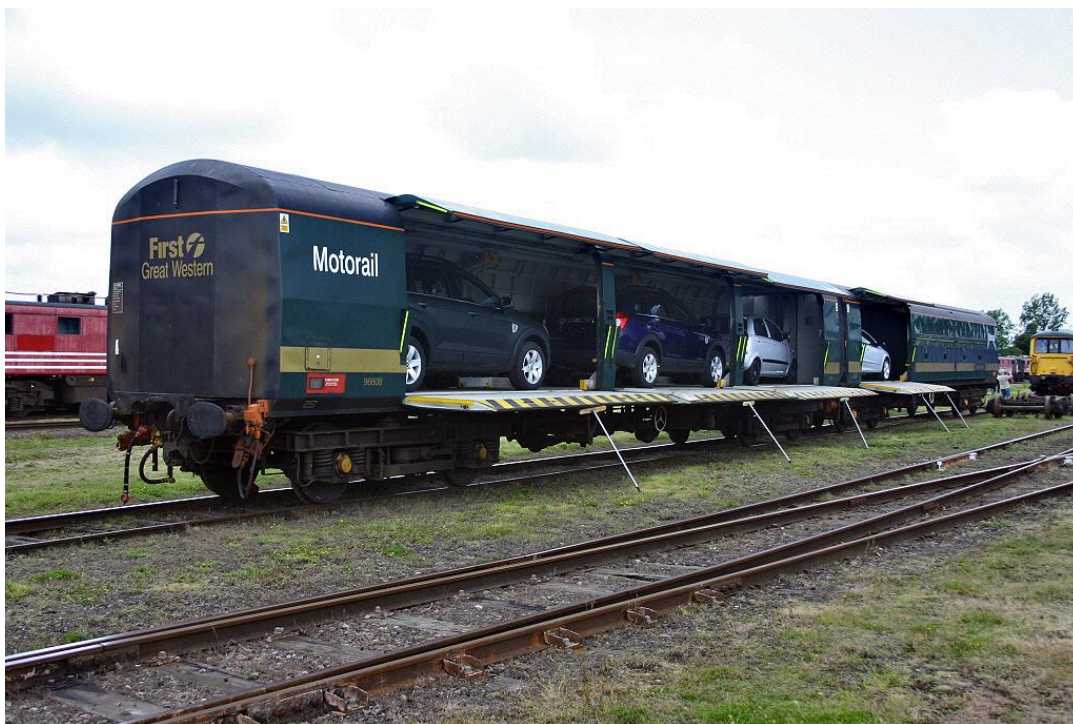
Obrázek 39: Vůz pro přepravu aut používaný v autovlacích ve Spojeném království [39]
