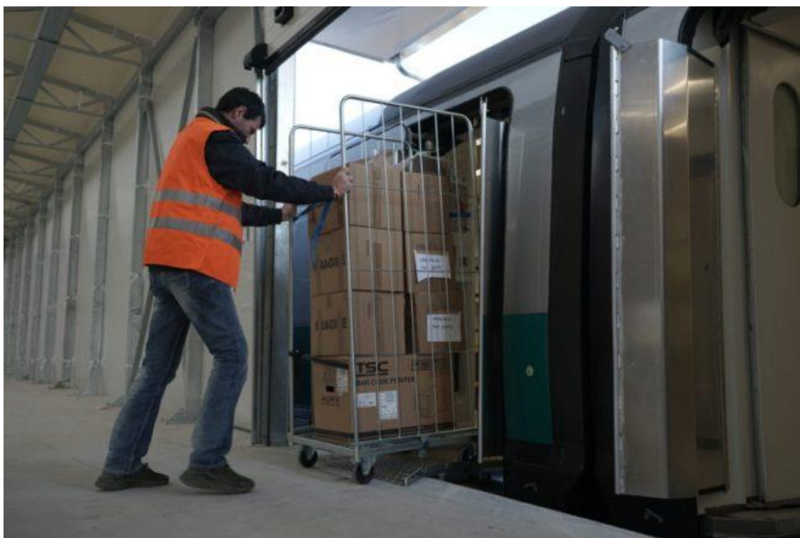
Obrázek 16: Nakládání rollkontejneru do jednotky ETR 500 M-01 Fast [14]
