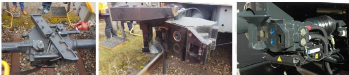
vlevo spojené spřáhlo demonstrační soupravy projektu „5L“ uprostřed rozpojené spřáhlo demonstrační soupravy projektu „5L“ vpravo spřáhlo se stupněm automatizace 5 na osobní jednotce
