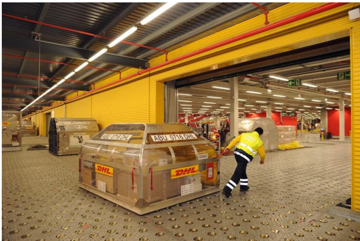
Obrázek 66: Plocha s rolnami pro manipulaci s ULD (na snímku atypický typ) [81]
