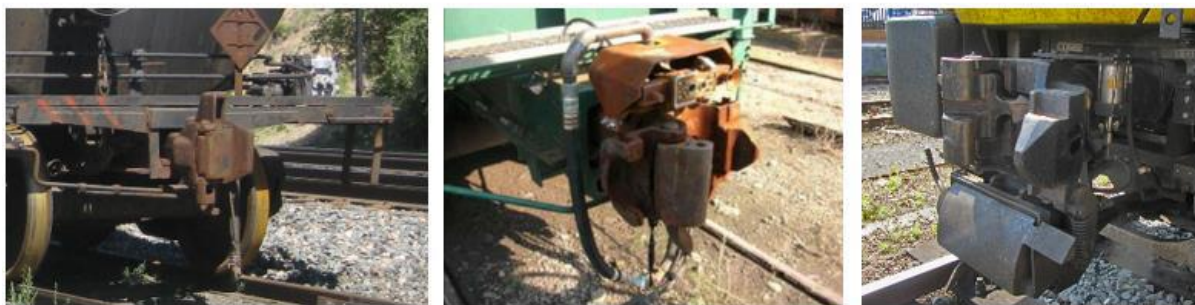
zleva: varianta se zábranou proti vysunutí, prototyp typu F (úroveň 5), britské spřáhlo Buckeye (úroveň 5)
