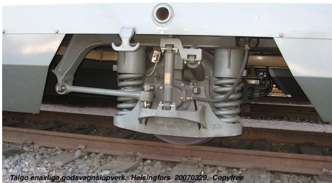
Obrázek 36: Pojezd TS25SA vozu Hccmqqr [36]
