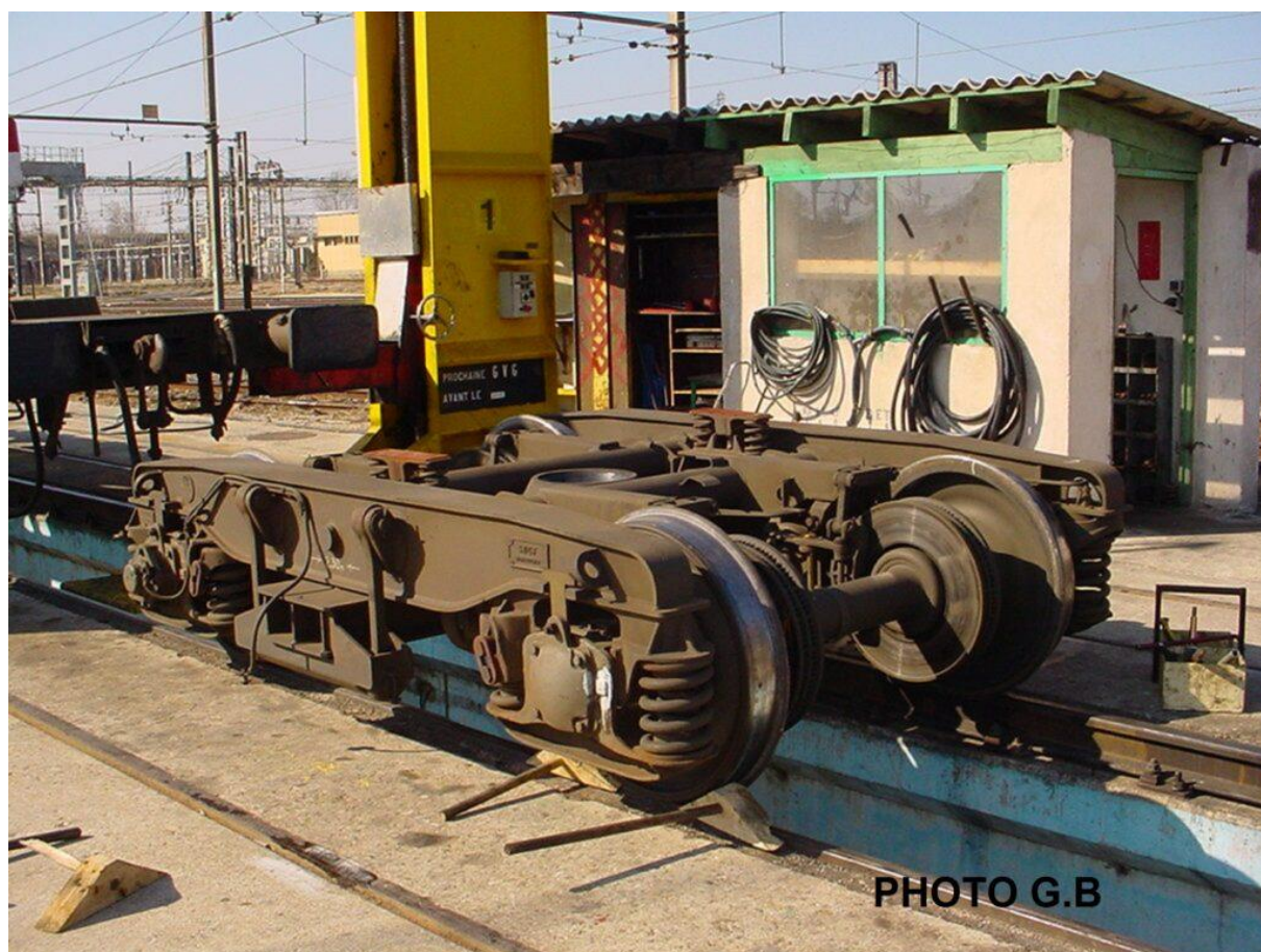
Obrázek 43: Podvozek Y 37 B [44]
