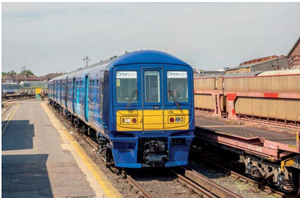
Obrázek 21: Nákladní verze jednotky řady 319 dopravce Orion High Speed Logistics [18]
