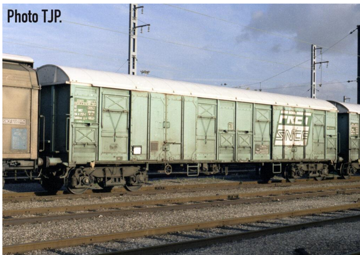
Obrázek 44: Vůz G13 s podvozky Y 37 A [44]
