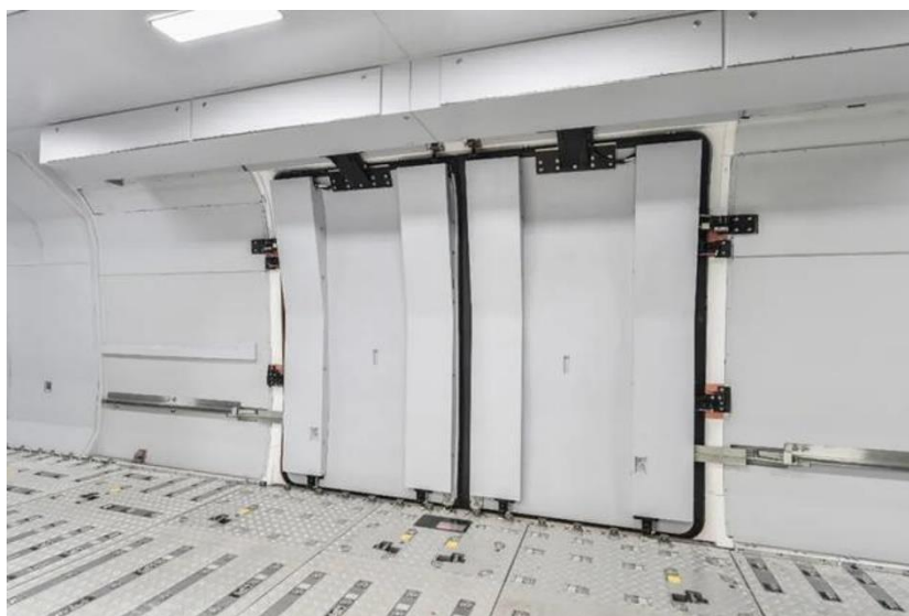
Obrázek 20 (opětovné zobrazení): Dveře nákladového prostoru vysokorychlostní jednotky CRRC [15]
