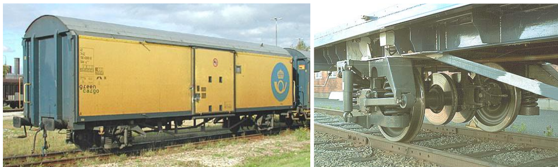
Obrázky 58 a 59: Poštovní vůz Gvlss-y (vlevo) a jeho pojezd TF25SA (vpravo) [1]
