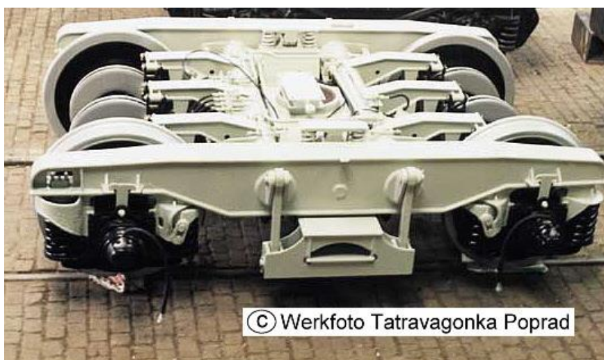
Obrázek 46: Podvozek Y 37 VVR výrobce Tatravagonka Poprad [47]
