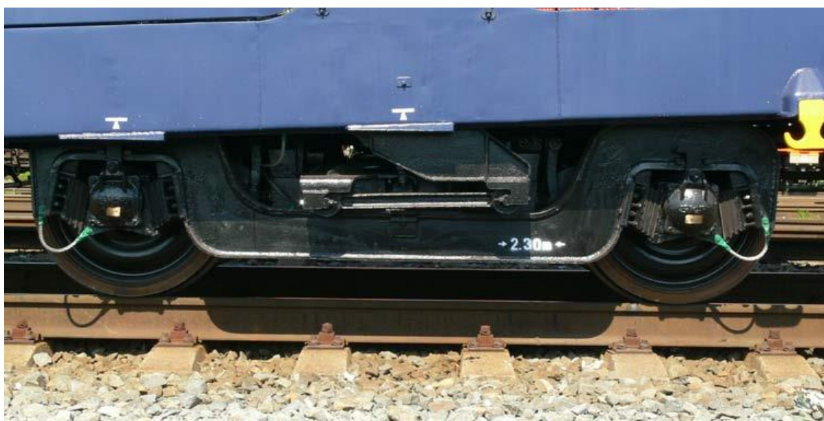
Obrázek 34: Podvozek Y30 vozu DDm 916 [34]
