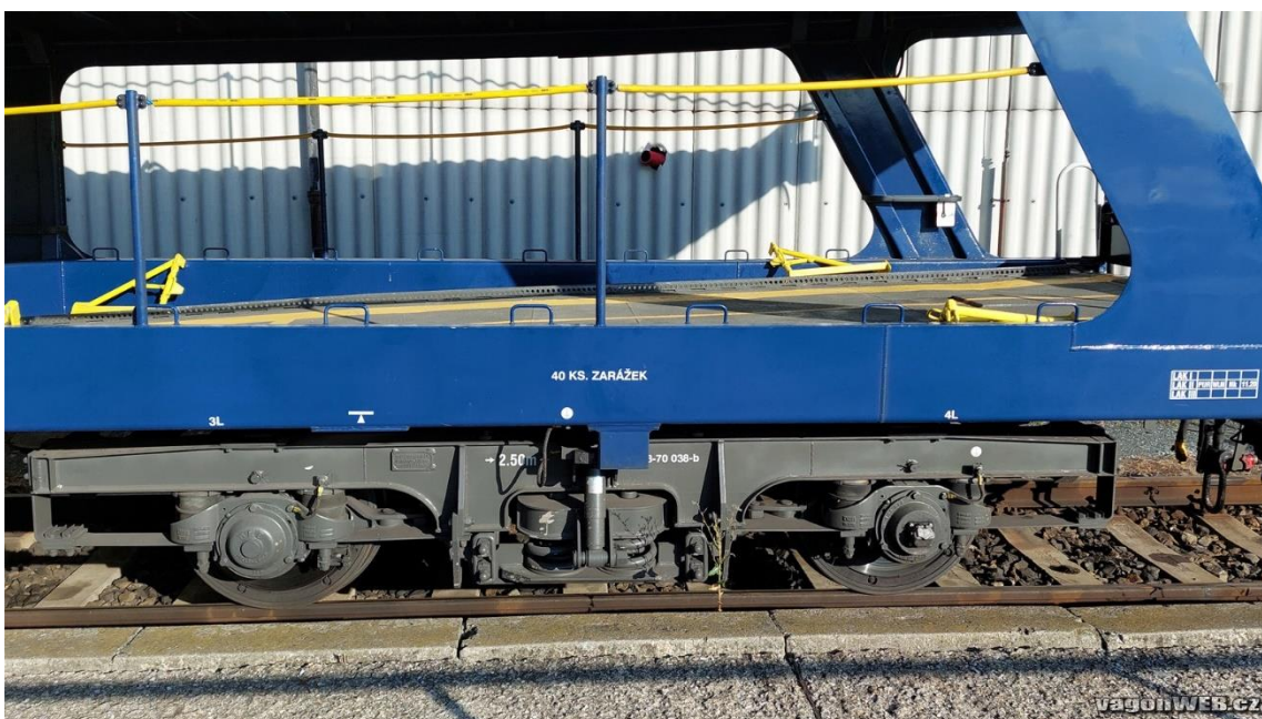
Obrázek 32: Podvozek MD 44 vozu DDm 915 [32]
