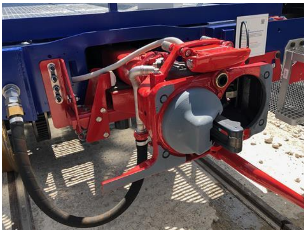
Obrázek 87: Spřáhlo CargoFlex Typ Scharfenberg [109]
