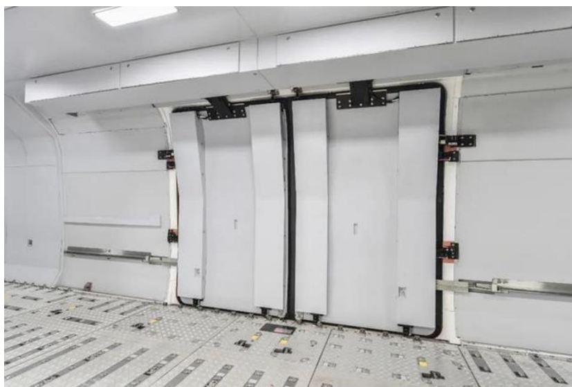
Obrázek 20: Dveře nákladového prostoru vysokorychlostní jednotky CRRC [15]
