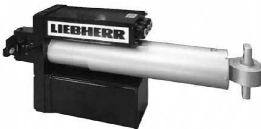
Obrázek 29-Systém aktivního natáčení podvozku [14]
