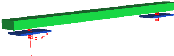
Obrázek 48 - 3. vlastní tvar kmitu - protiběžné houpání
