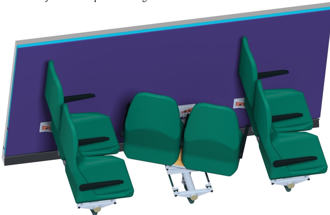
Obrázek 3.2.3 – Druhý kritický úhel natočení sedadel se standardní polohou sedadel vůči otočnému mechanismu
