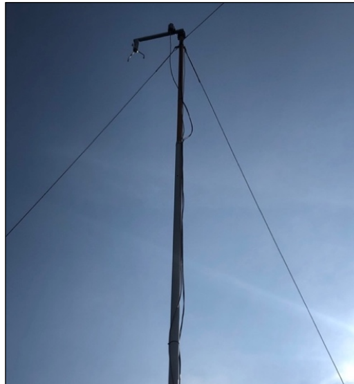
Obrázok 1: Ultrazvukový anemometer umiestnený pri meteorologickej stanici na Letisku Václava Havla v Prahe.
