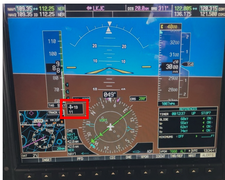
Obrázok 7: Zobrazenie rozloženia zložiek vetra v lietadle vybavenom navigačným prístrojom Garmin 1000.
