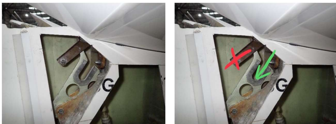
Obrázek 4: Rozpojené řízení výškového kormidla [4]
