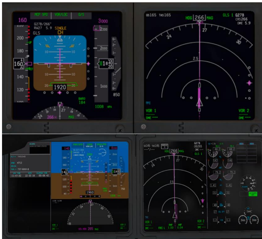
Obrázek 13: PFD a ND při GLS, zdroj: zpracováno autorem za použití SW X-Plane 11
