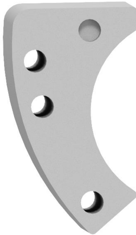
Obr. 104 - Nástroj č. 2 s dutinami pro výztuž ve formě čepů
