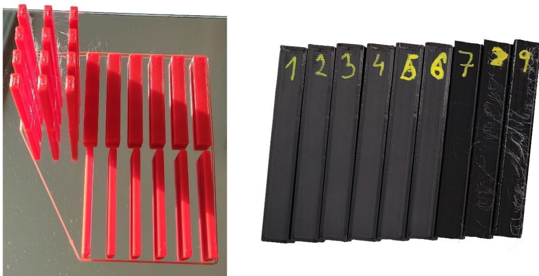
Obr. 60 - Vytištěné vzorky pro zkoušku tříbodovým ohybem
