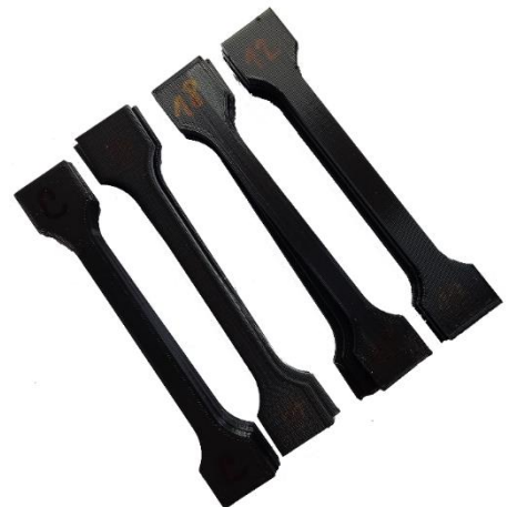
Obr. 46 - Vytištěné vzorky pro zkoušku tahem
