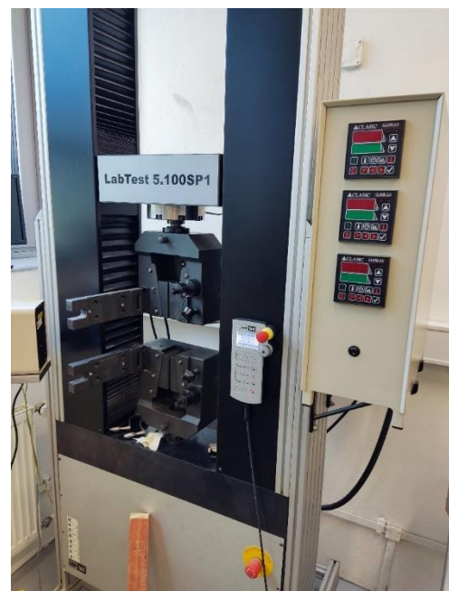
Obr. 39 - Univerzální zkušební trhací stroj LabTest Model 5.100SP1
