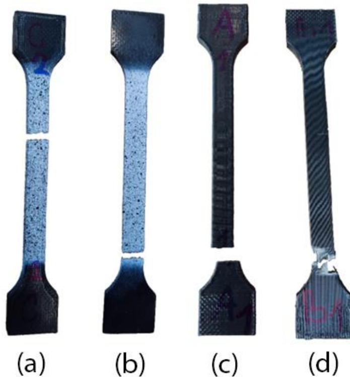
Obr. 58 - Vzorky po zkoušce tahem
