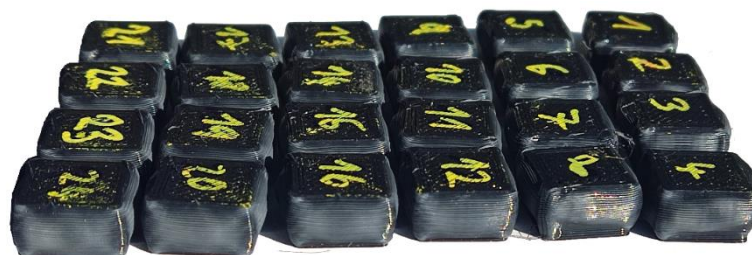
Obr. 44 – Zdeformované vzorky po zkoušce tlakem
