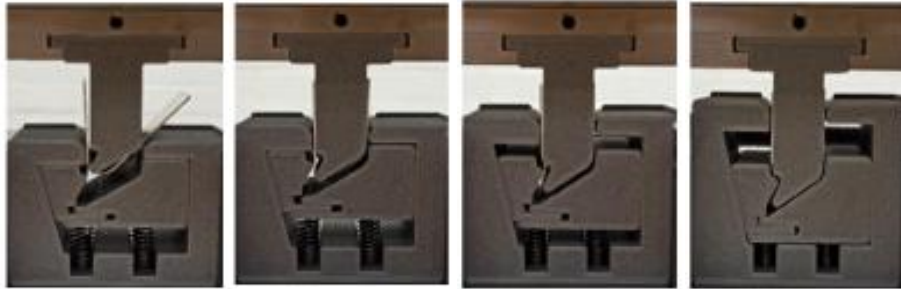
Obr. 30 - Postupný průběh lisování (zleva doprava) [54]
