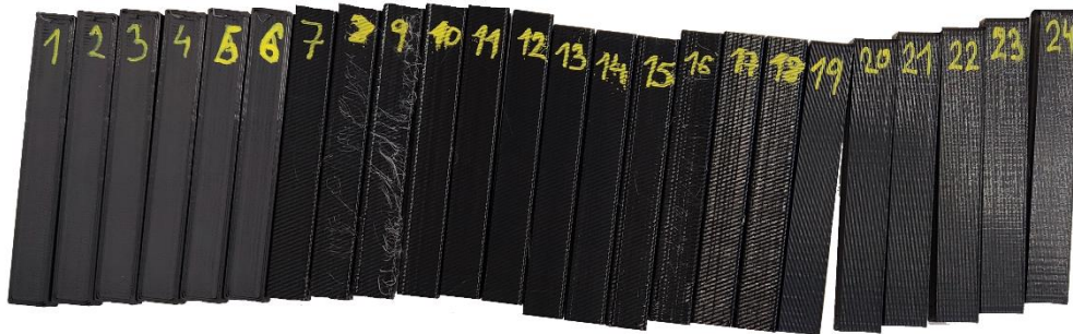
Obr. 69 - Vytištěné vzorky pro zkoušku vzpěru
