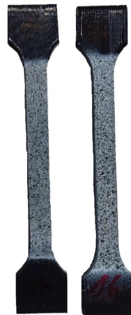
Obr. 49 – Zkušební tělesa pro zkoušku tahem opatřena černobílým patternem
