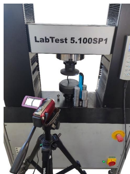
Obr. 71 - Průběh zkoušky vzpěru
