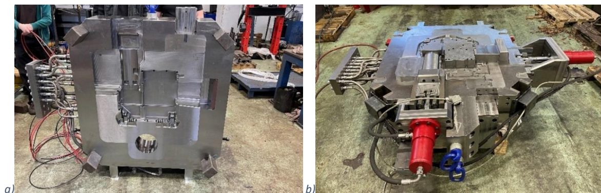
Obrázek 45 - a) pevná polovina formy; b) pohyblivá polovina formy
