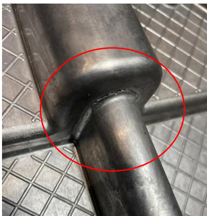
Obrázek 49 - Systematická chyba při vytlačování odlitku z formy
