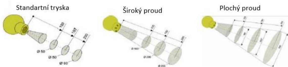
Obrázek 27 - Dělení trysek dle tvaru proudu [35]
