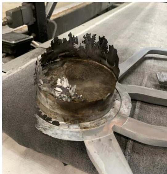
Obrázek 55 - Slupka v místě tablety
