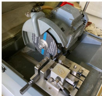
Obr. 68 Nařezané plátky (vlevo) a postup zakracování vzorků na metalografické kotoučové pile (vpravo)
