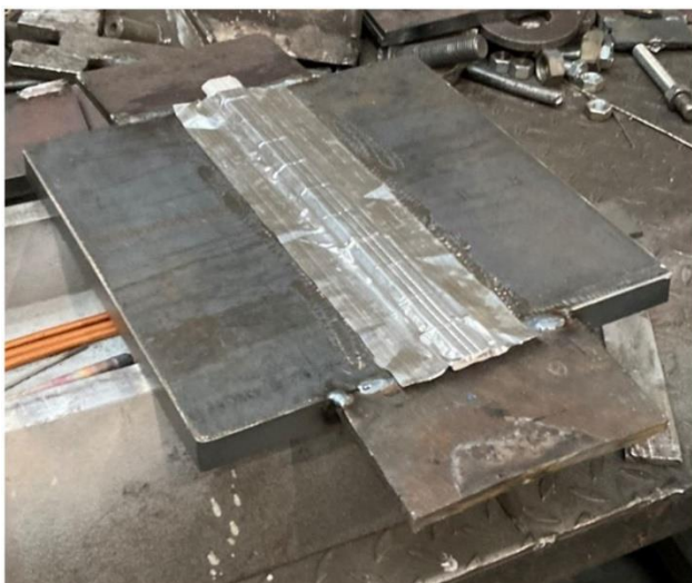
Obr. 36 Podlepení kořene keramickou podložkou NST Kerback FR 271009T
