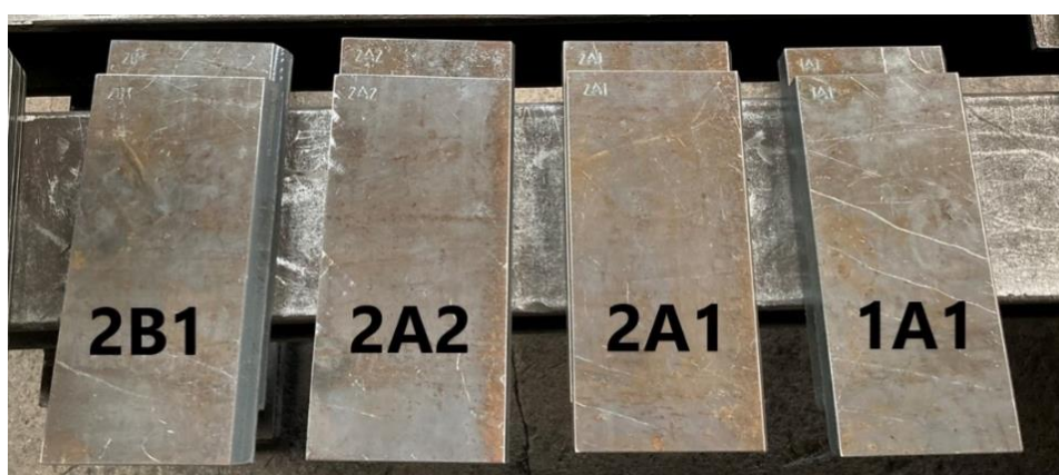
Obr. 28 Vzorky připravené tepelným dělením plazmou
