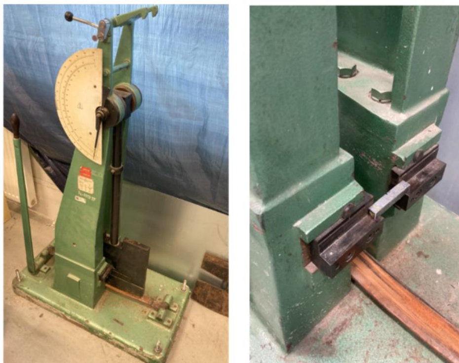
Obr. 66 Zkušební zařízení pro zkoušku rázem v ohybu s uložením zkušebního vzorku
