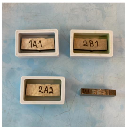
Obr. 69 Vzorky připravené pro zalití akrylovou pryskyřicí VersoCit-2 (vlevo) a broušení vzorků (vpravo)
