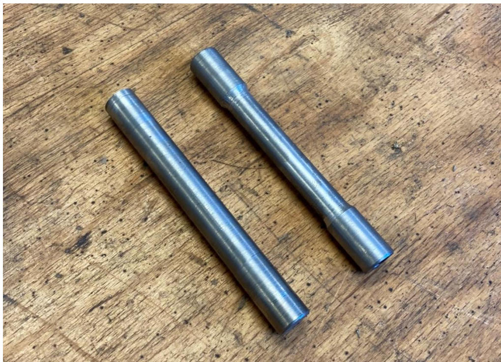
Obr. 56 Stav zkušebního vzorku po hrubování a po obrobení na konečný tvar
