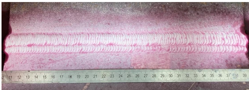
Obr. 50 Kapilární zkouška vzorku 2A1
