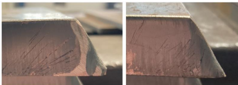
Obr. 30 Ukázka úkosů s otupením a bez otupení: Vlevo pro vzorek 1A1 a vpravo pro vzorek 2A1
