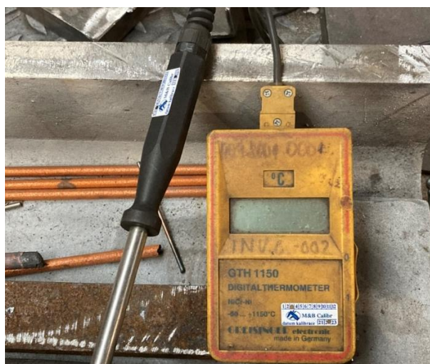
Obr. 34 Použitý dotykový teploměr GTH 1150 pro kontrolu teploty interpass
