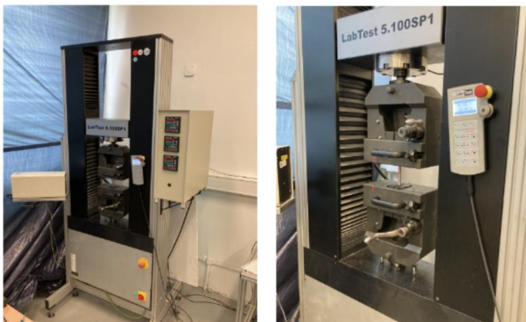
Obr. 58 Zkušební stroj LabTest a způsob upnutí vzorků
