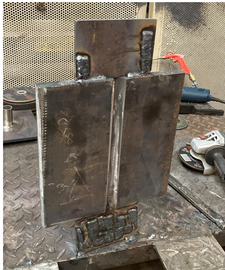
Obr. 40 Příprava vzorku 2A2 na svařování v poloze PF
