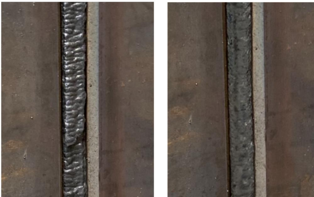
Obr. 43 Průběh svařování vzorku 2A2: Vlevo je viditelná struska vznikající jako vedlejší produkt svařování a vpravo je možné vidět stav po odstranění strusky
