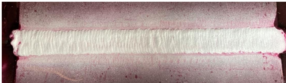
Obr. 49 Kapilární zkouška vzorku 2A2
