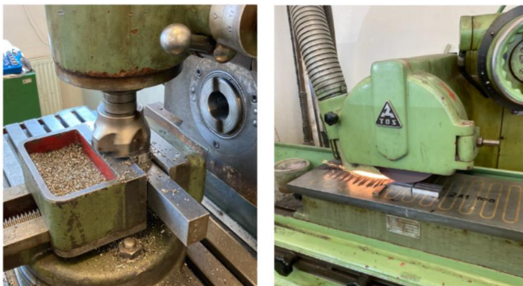
Obr. 63 Obrábění polotovarů pro zkoušku rázem v ohybu: Vlevo frézování a vpravo broušení na plocho
