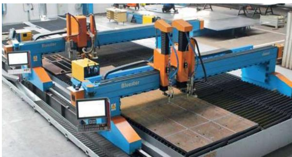
Obr. 27 CNC pálicí stroj Vanad Bluester ve firmě Baest
