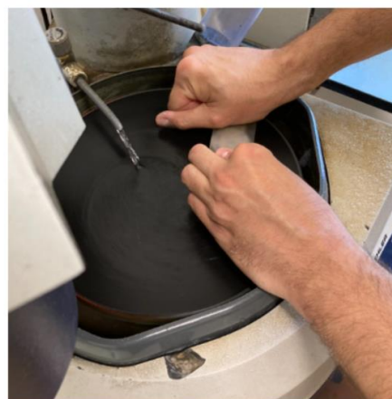
Obr. 69 Vzorky připravené pro zalití akrylovou pryskyřicí VersoCit-2 (vlevo) a broušení vzorků (vpravo)
