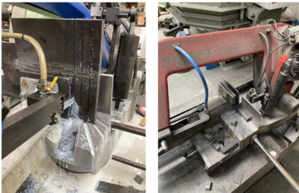
Obr. 54 Výroba polotovarů zkušebních vzorků pro tahovou zkoušku
