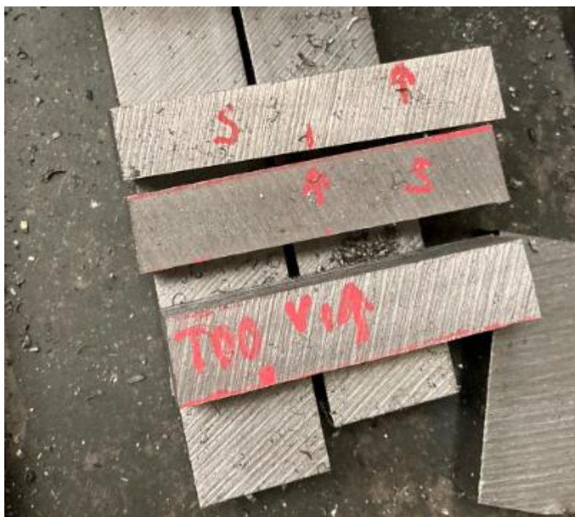
Obr. 62 Polotovary zkušebních vzorků pro zkoušku rázem v ohybu vyrobené řezáním
