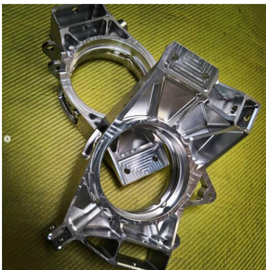
Obrázek 5 Obráběné těhlice týmu CTU CarTech [5]
