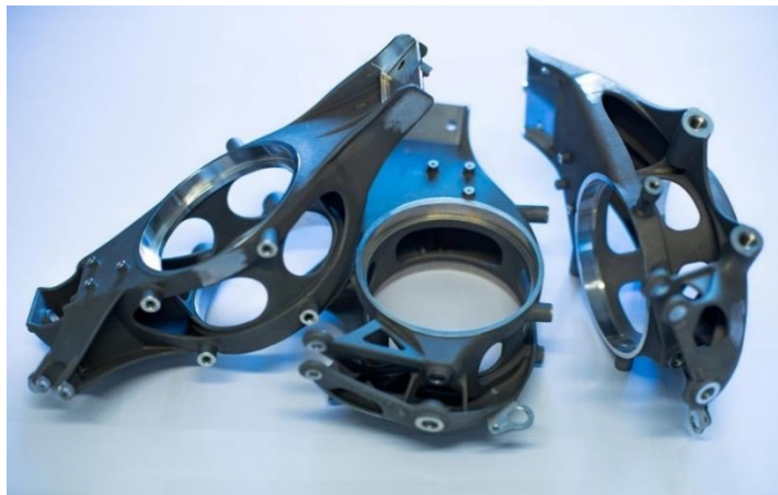
Obrázek 8 Odlévané těhlice týmu Racetech [8]
