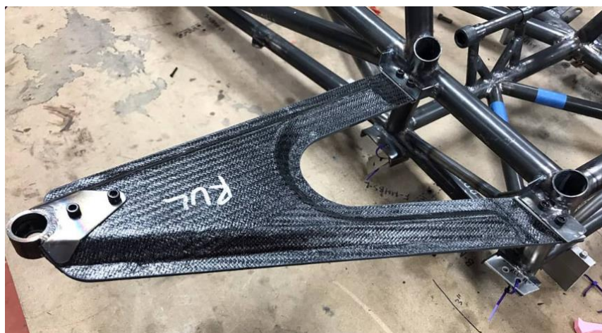
Obrázek 4 Uhlíková ramena týmu Lehighracing [4]
