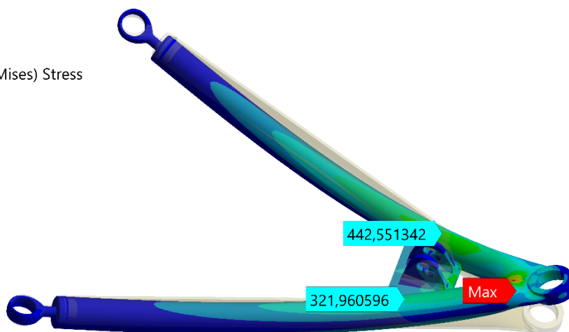
Obrázek 31 Oblast maximálního redukovaného napětí na horním rameni (mezní stav I)
