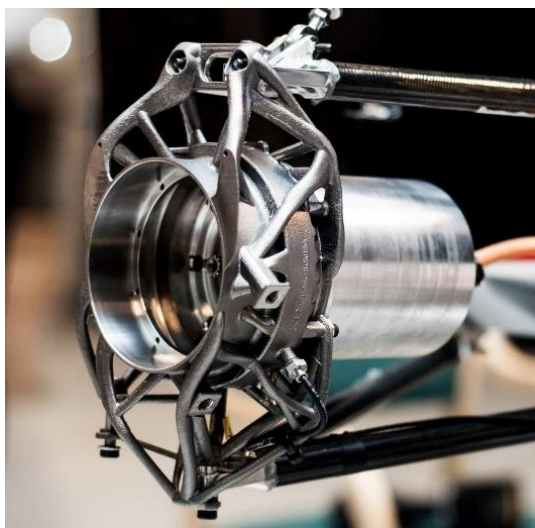
Obrázek 6 3D tištěná těhlice týmu Revolve NTNU [6]
