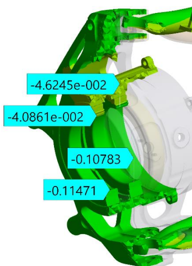
Obrázek 78 Posuvy v ose y s hodnotami pro výpočet změny odklonu na ložiskách
