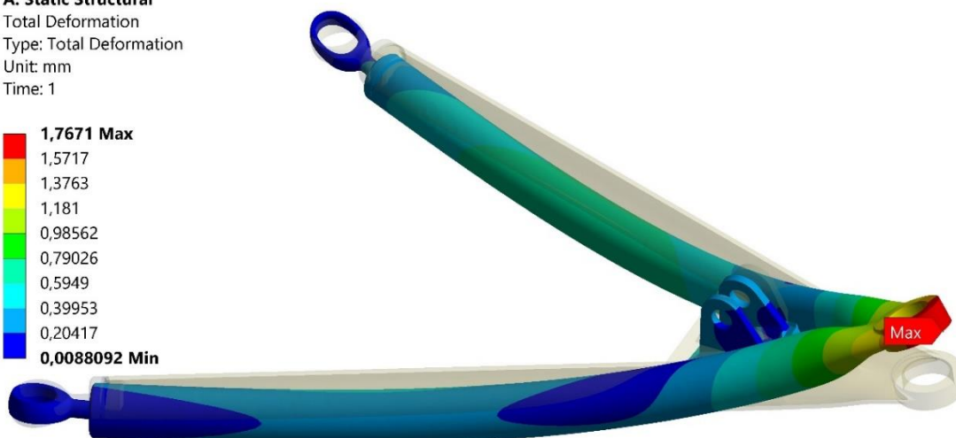
Obrázek 35 Deformace horního ramene (mezní stav I)
