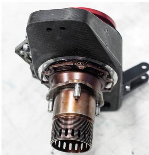
Obrázek 7 Kompozitní těhlice týmu TU Gratz Racing [7]
