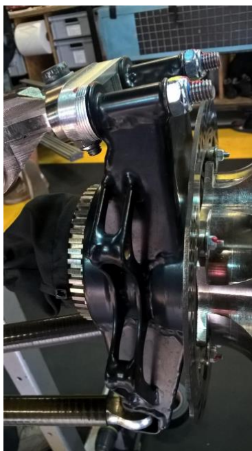
Obrázek 9 Svařované těhlice týmu KA Racing [9]
