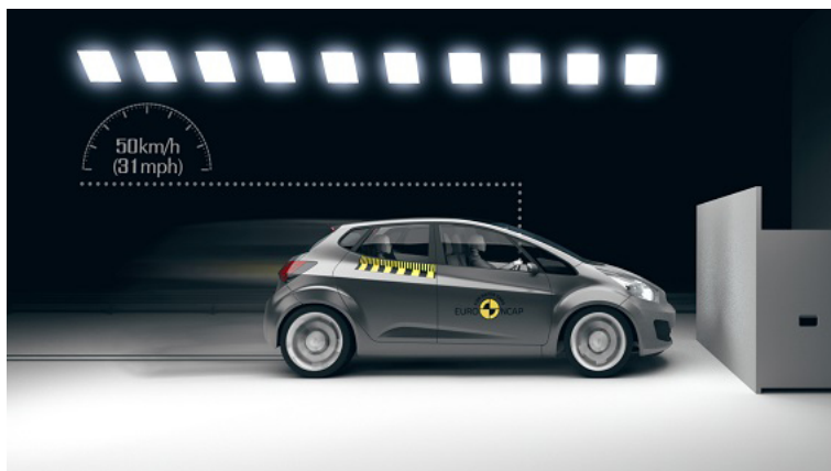
Obr. 37: Čelní náraz do deformovatelné bariéry se 100 % překrytím [22]
