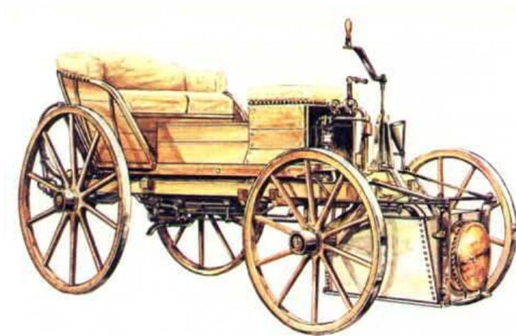
Obr. 2: Parní vůz Jozefa Božka postavený na nosném rámu [12]
