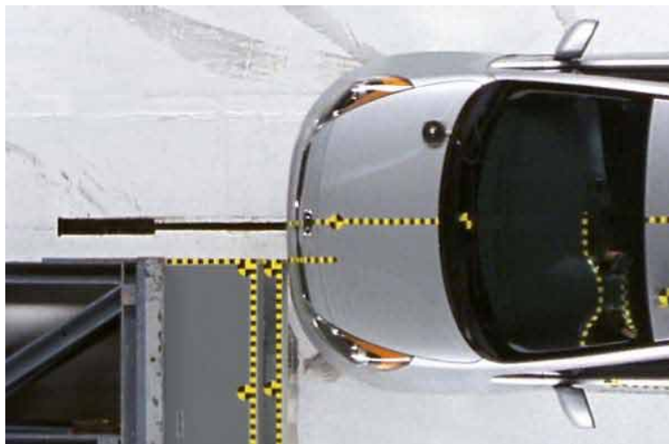
Obr. 41: Čelní náraz do deformovatelné bariéry se 40 % překrytím [21]
