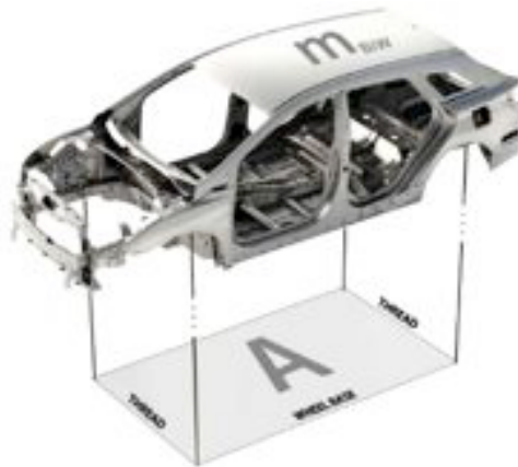
Obr. 28: Plocha karoserie pro výpočet lightweight indexu [23]
