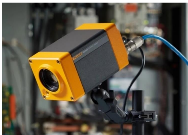
Obr. 19 - Stacionární termokamera Fluke RSE600 [10]
