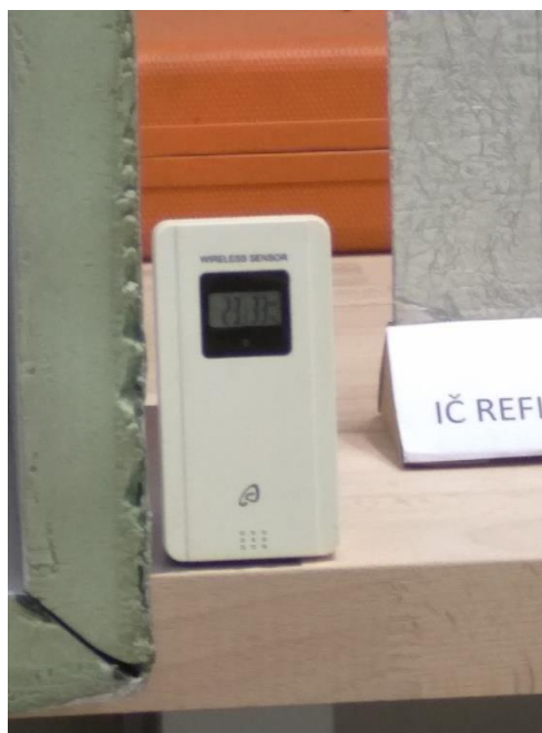
Obr. 66 - Modul pro měření relativní vlhkosti a teploty okolí
