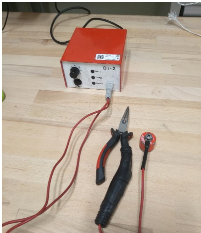
Obr. 48 - Kondenzátorový svařovací zdroj BT-2
