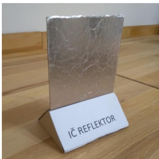
Obr. 64 - IČ Reflektor z kartonu a hliníkové folie
