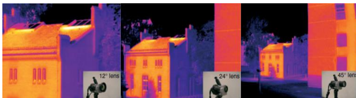
Obr. 26 - Vliv použití různých objektivů: 12^\circ teleobjektiv, 24^\circ standard, 45^\circ širokoúhlý objektiv (pozn.: označení objektivu odpovídá horizontálnímu zornému úhlu) (upraveno) [2]
