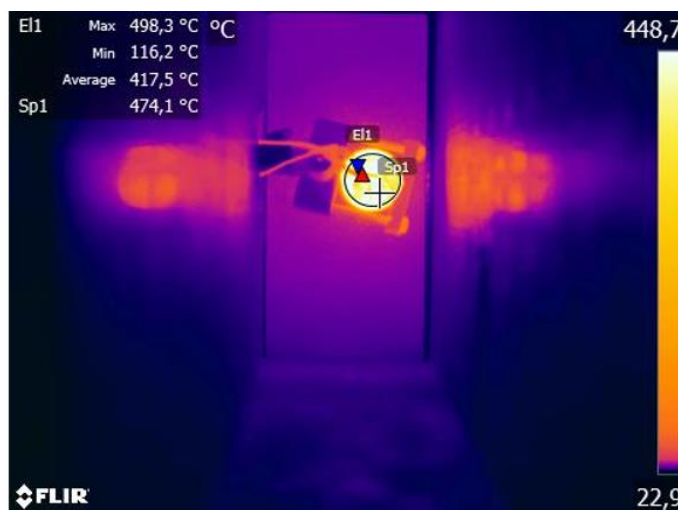
Obr. 63 - Rozdíl ve vyhodnocení teploty při použití měřících funkcí bod a oblast
